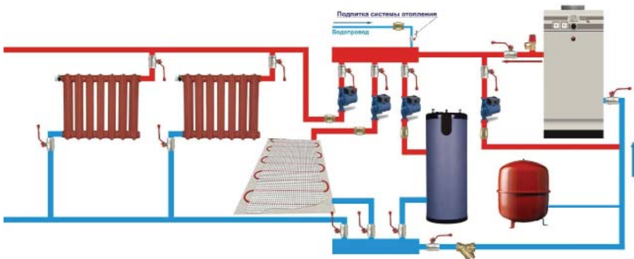
Рисунок 6. Схема подключения котла с общим коллектором.
