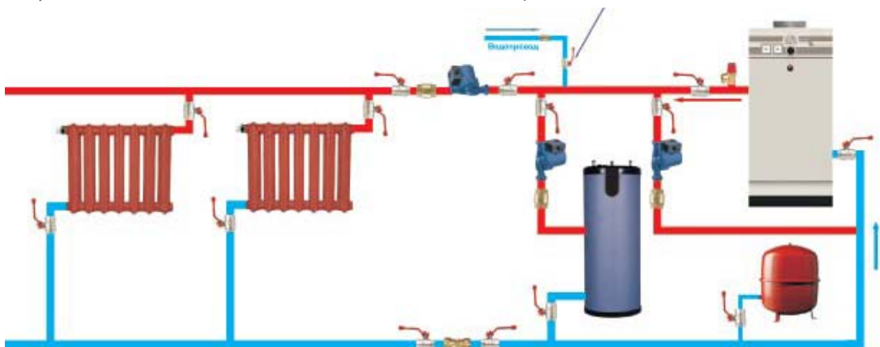
Рисунок 7. Схема подключения котла с принудительной циркуляцией теплоносителя.
