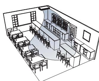
Направление воздушного потока из **подпотолочного** блока можно менять по горизонтали и по вертикали.
