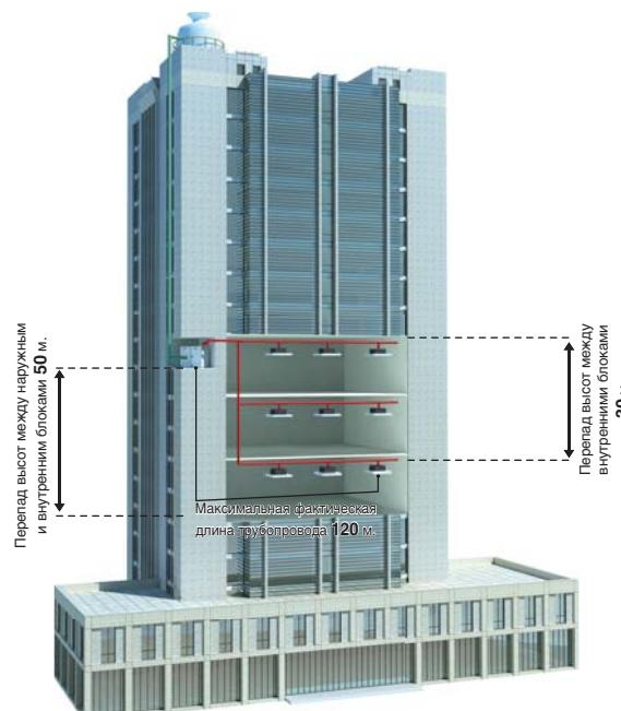
Сухие охладители можно разместить на значительном удалении от наружных блоков, что позволяет применять системы в высотных зданиях. Возможно создать комплекс с общим водопроводом и рекуперацией энергии, при котором тепло, отданное блоками жидкости, работающими на охлаждение одной зоны объекта, может использоваться в теплообменниках блоков системы, обогревающей другие помещения.
