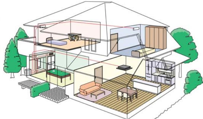
**Мультисистемы**, к которым можно подключить до пяти внутренних блоков, отличаются свободным комбинированием, широким выбором внутренних блоков по типам и высокой производительностью.
