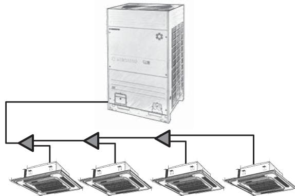
В наружных блоках размещены основные устройства (компрессоры, конденсаторы, расширительные вентили, система управления и вспомогательное оборудование), которые производят «холод» и «тепло» в системе кондиционирования. Внутренние блоки обеспечивают кондиционирование воздуха в помещениях (охлаждение, нагрев, автоматическое поддержание заданной температуры, осушку, перемешивание воздуха, очистку от пыли).
