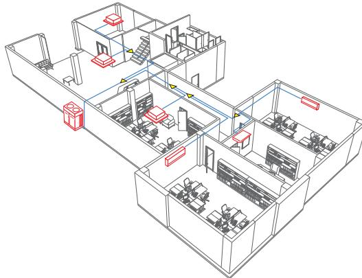
Внутренние и наружные блоки, соединенные трубопроводом и электрическими кабелями, образуют единую центральную систему кондиционирования.
