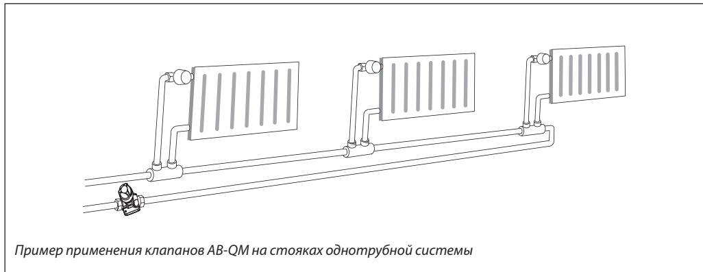
В однотрубной системе отопления клапаны AB-QM устанавливаются на каждом стояке и могут использоваться в качестве регулятора — ограничителя расхода.
