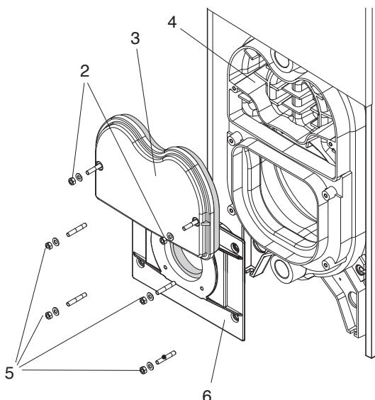
Для дальнейшего облегчения операций чистки можно также удалить гайки (5) и снять нижнюю дверцу (6).
