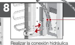
Realizar la conexión hidráulica
