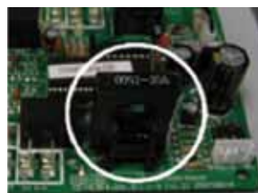
Защита компрессора по току
