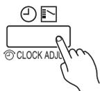
Нажмите кнопку выбора режима работы таймера для включения таймера (ON) или выключения таймера (OFF).
