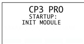
Пароувлажнитель проводит **тест системы**. Загораются все три светодиода, и на дисплее появляется текст (см. изображение). Если в системе обнаруживается неисправность, на дисплее по является соответствующее сообщение о неисправности.
