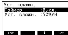
Таймер деактивирован, уставка влажности регулируется (установка завода: 50 %отн.вл., Возможности выбора: 15...95 %rH)
