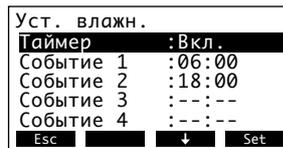
Если таймер активирован, может быть определено до 8 положений переключения (события 1 - 8) с различными уставками влажности.
