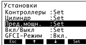
Выберете “**Пред. мощн.**” в меню настроек, нажмите кнопку **<Set>**. Установкой параметров в подменю “Пред. мощн.” Вы определяете, как должен функционировать Condair CP3: с фиксированным ограничением производительности (настраивается на заводе) или с таймером, регулирующим ограничение производительности.
