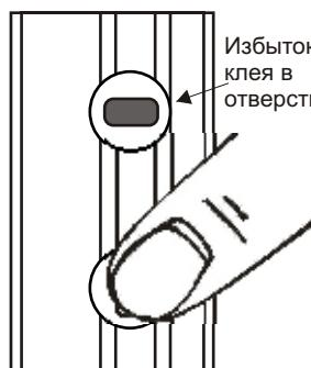
После прижатия задней стенки распределителя к поверхности от. прибора, в отверстиях крышки появляется избыток клея.
