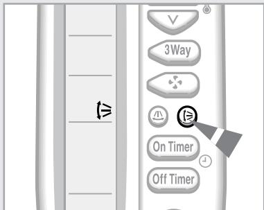
**Вы можете отрегулировать положение внешней воздушной пластины в верхней части устройства, чтобы повысить эффективность работы кондиционера.**
