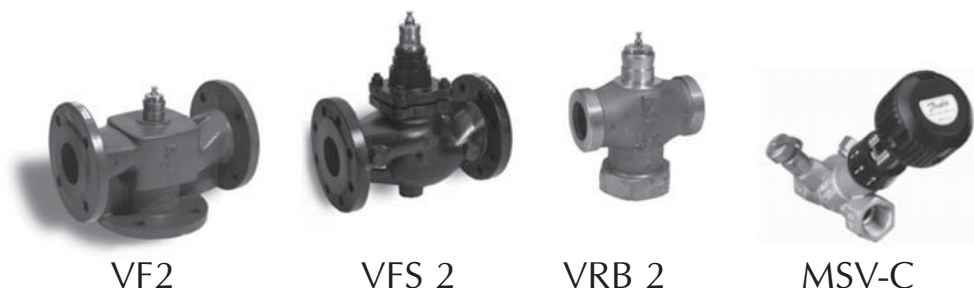
Рис. 6.10. Регулирующие клапаны с логарифмической расходной характеристикой
