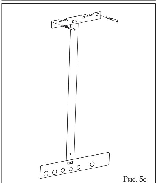
В комплект поставки котла входит планка крепежа к стене (рис. 5а - деталь 1) с набором дюбелей и винтов, а также разборная металлическая рама (рис. 5а - детали 2 и 3), позволяющая наметить в стене места крепежных отверстий и места подвода к котлу воды и газа. Подсоединить раму к планке крепежа и приложить ее к стене. С помощью уровня с пузырьком воздуха (рис. 5б) убедиться, что нижняя планка (рис. 6 - деталь С) находится в горизонтальном положении.
