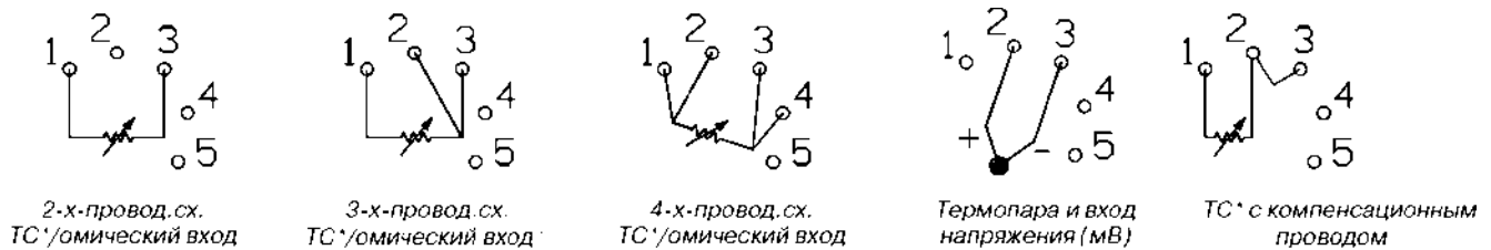
Рис.7. Схема подключения одинарного первичного преобразователя к Rosemount 3144P-HART/4-20 мА.
