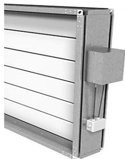
Особенностью утепленного клапана KVU-NZn-P является использование в конструкции периметрального обогрева в виде расположенного по наружному периметру клапана гибкого саморегулирующегося нагревательного кабеля, постоянно подключенного в сеть переменного тока 220В и предотвращающего образование наледи на кинематике клапана.
