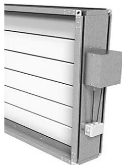
Особенностью утепленного клапана KVV-N-P является использование в конструкции периметрального обогрева в виде расположенного по наружному периметру клапана гибкого саморегулирующегося нагревательного кабеля, постоянно подключенного в сеть переменного тока 220В и предотвращающего образование наледи на кинематике клапана.
