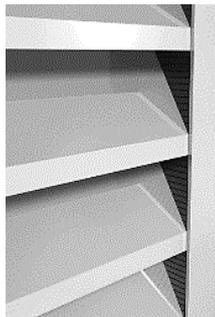
Решетки РН-129 представляют собой прямоугольную раму из алюминиевого профиля с установленными в нее неподвижными жалюзи (ламелями) под углом 45 градусов, с шагом 50 мм.
