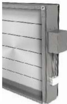
Особенностью утепленного коррозионностойкого клапана KVV-N-AISI-P является использование в конструкции периметрального обогрева в виде расположенного по наружному периметру клапана гибкого саморегулирующегося нагревательного кабеля, постоянно подключенного в сеть переменного тока 220В и предотвращающего образование наледи на кинематике клапана.
