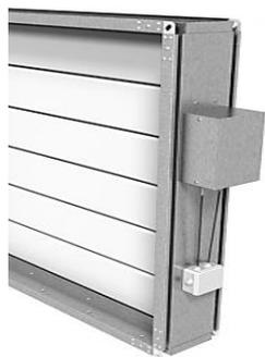
Особенностью утепленного клапана KVU-NZn-PS является использование в конструкции периметрального обогрева, а также обогрева по всей площади рабочего сечения в виде закрепленного гибкого саморегулирующегося нагревательного кабеля, постоянно подключенного в сеть переменного тока 220В и предотвращающего образование наледи на кинематике клапана.
