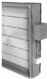
Особенностью утепленного коррозионностойкого клапана KVU-N-AISI-PS является использование в конструкции периметрального обогрева, а также обогрева площади рабочего сечения в виде расположенного по наружному периметру и в трубках, проходящих в местах соприкосновения лопаток гибкого саморегулирующегося нагревательного кабеля, постоянно подключенного в сеть переменного тока 220В и предотвращающего образование наледи на кинематике клапана.
