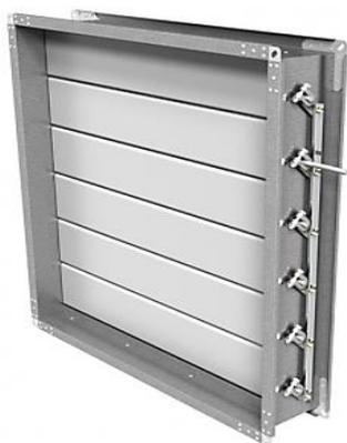
**MIRAVENT UVK** - Клапан воздушный усиленный универсальный предназначен для регулирования потока воздуха в системах вентиляции и кондиционирования в условиях температур от +40°C до -40°C. Обеспечивает герметичность объема воздуха внутри вентиляционных сетей. Клапан UVK имеет повышенную жесткость за счет конструкции алюминиевых лопаток, кинематике и корпуса клапана из оцинкованной стали. При этом допустимый перепад давления на закрытом клапане допустим до 1800 Па.
