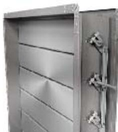
Клапан KVV-N-AISI-P состоит из четырехстенного коробчатого корпуса, выполненного из нержавеющей стали, лопатка клапана выполнена из формованной усиленной нержавеющей стали, примыкание створок лопаток выполнено в форме замкового уплотнения. Лопатки клапана приводятся в движение с помощью рычагов и тяг. Ось регулирования может быть расположена на любой из лопаток на любой стороне блока. В конструкции клапана исключено применение пластиковых элементов.
