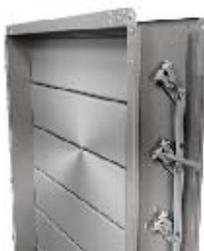
Клапан KVU-N-AISI-PS состоит из четырёхстенного коробчатого корпуса, выполненного из нержавеющей стали, лопатка клапана выполнена из формованной усиленной нержавеющей стали, примыкание створок лопаток выполнено в форме замкового уплотнения. Лопатки клапана приводятся в движение с помощью рычагов и тяг. Ось регулирования может быть расположена на любой из лопаток на любой стороне блока. В конструкции
