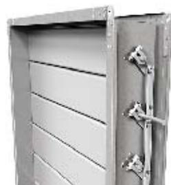
Клапан KVU-NZn-PS состоит из четырёхстенного коробчатого корпуса, выполненного из оцинкованной стали, лопатка клапана — выполнена из усиленной оцинкованной стали, примыкание створок лопаток выполнено в форме замкового уплотнения. Лопатки клапана приводятся в движение с помощью рычагов и тяг. Ось регулирования может быть расположена на любой из лопаток на любой стороне блока. В конструкции клапана исключено применение пластиковых элементов.
