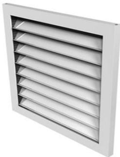
**MIRAVENT PH 101** - Декоративная нерегулируемая наружная вентиляционная решетки жалюзийного типа из усиленного алюминиевого профиля. Предназначена для подачи и удаления воздуха в системах вентиляции. Монтируются на фасадах зданий и сооружений, обеспечивают защиту воздухозабора в помещении от дождя и снега.
