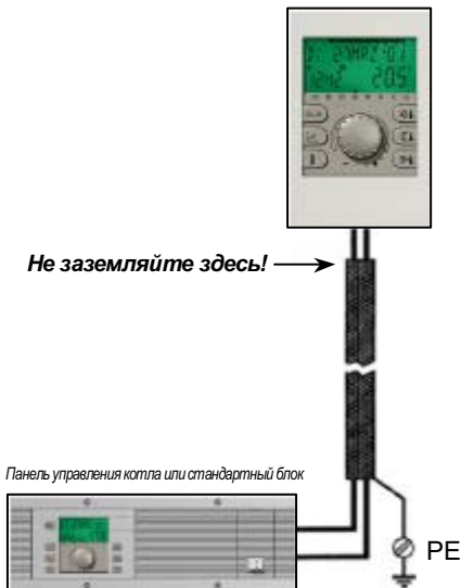
Рис. 4: Одноточечное заземление информационного кабеля
