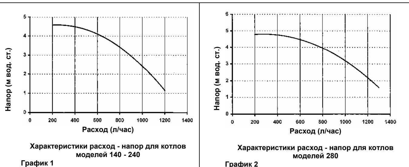
Примечание: В модели Nuvola 3 240 может быть установлен насос увеличенной мощности с характеристиками, аналогичными характеристикам насоса для модели Nuvola 3 280.
