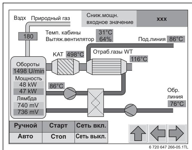
Рис. 23 Рабочий экран «Обзор блок-ТЭС без регулирования ПЛ»
