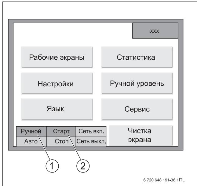
Рис. 11 Включение установки
