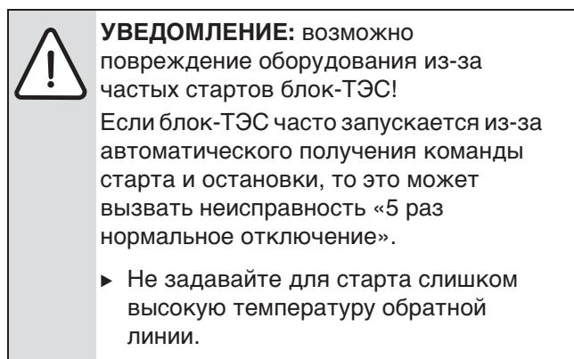
**i** Чтобы обеспечить правильную работу блок-ТЭС, установите дополнительный датчик температуры на обратную линию непосредственно перед её точкой подключения к машине. Температуру дополнительного котла необходимо учитывать в задаваемых параметрах.
