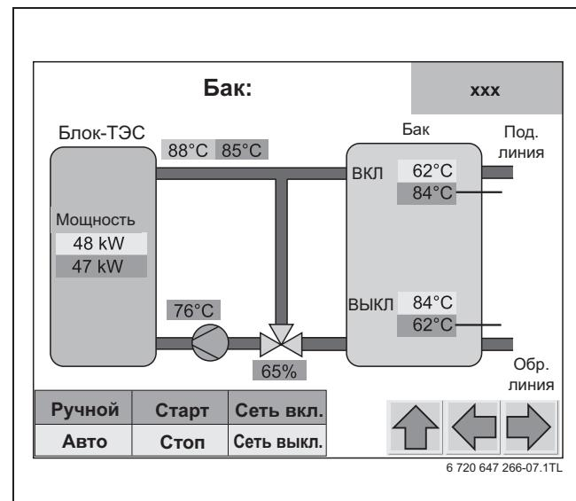
Рис. 25 Рабочий экран «Бак» с трёхходовым клапаном
