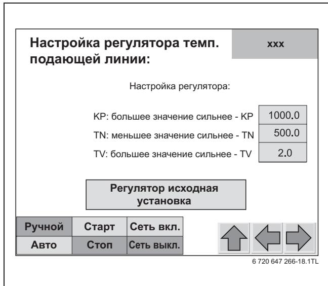
Рис. 37 Экран «Настройка регулятора температуры подающей линии»
