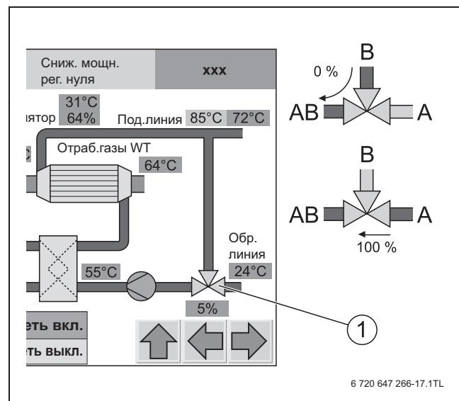
Рис. 36 Потоки через трёхходовой клапан
