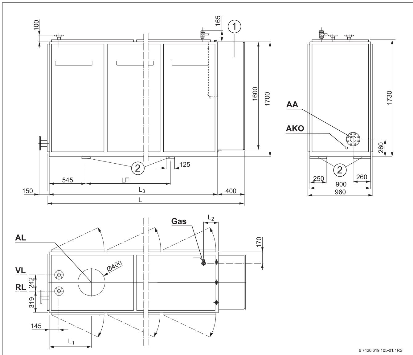
Рис. 7 Размеры и подключения EN70 (в мм)
