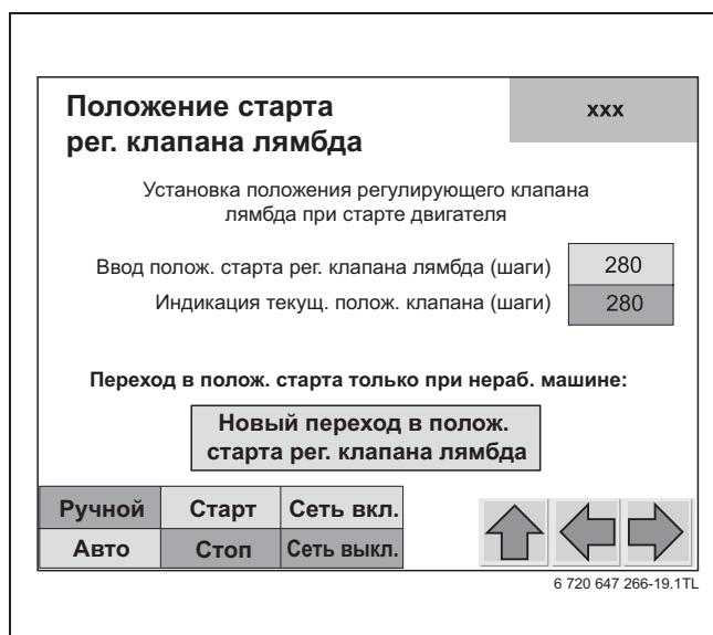
Рис. 38 Экран настройки «Положение старта лямбда-регулирующего клапана»
