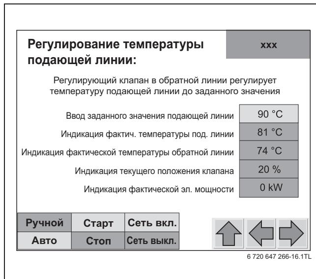
Рис. 35 Экран настройки «Регулирование температуры подающей линии»
