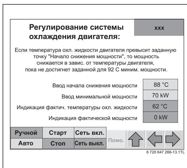
Рис. 31 Экран настройки «Регулирование системы охлаждения двигателя»
