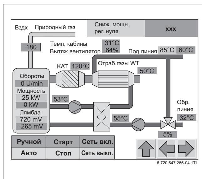
Рис. 22 Рабочий экран «Обзор блок-ТЭС с регулированием ПЛ»
