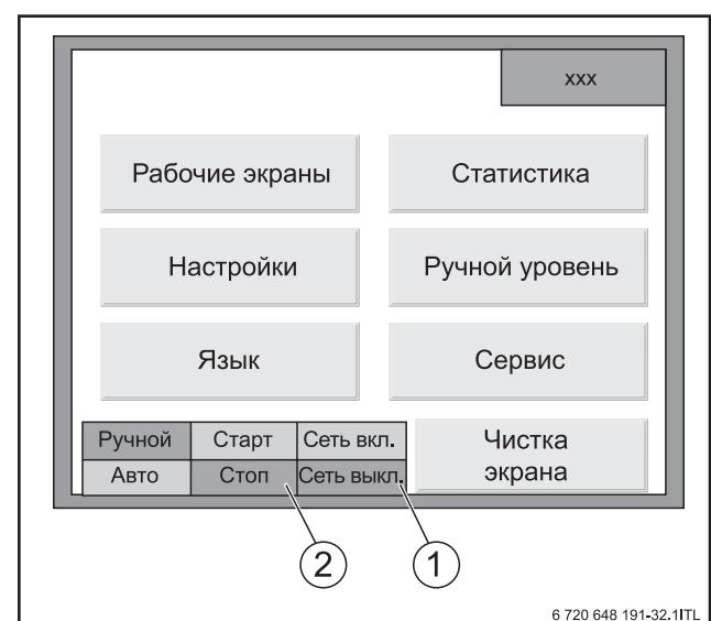
Рис. 13 Выключение установки
