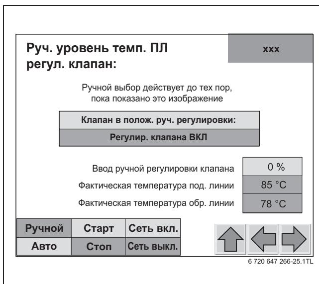
Рис. 52 Ручной уровень «Регулирующий клапан температуры ПЛ»
