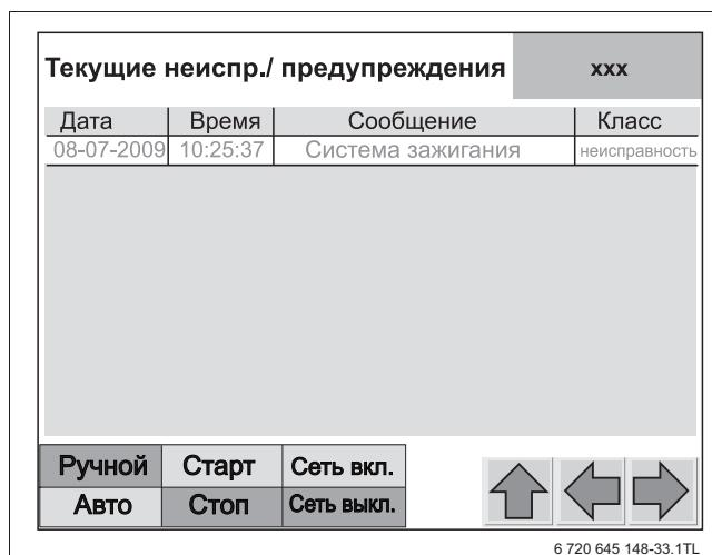
Рис. 46 Экран статистики «Текущие неисправности/предупреждения»
