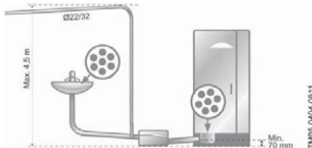
Рис. 51. Для раковины и душевой кабины (SOLOLIFT2 D-2)
