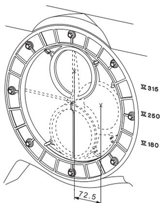
**Рис. 86.** Основное впускное отверстие с эксцентрическим диском
