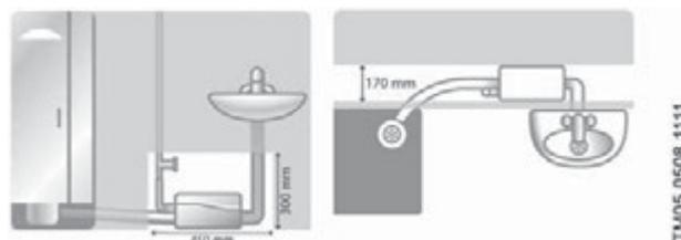
Рис. 52. Для раковины и душевой кабины (SOLOLIFT2 D-2)
