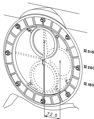
Рис. 91. Основное впускное отверстие с эксцентрическим диском
