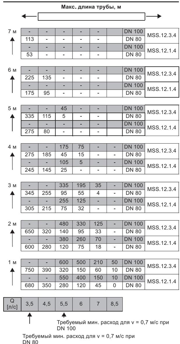
Рис. 81. Максимальная длина вертикальных или горизонтальных напорных трубопроводов
