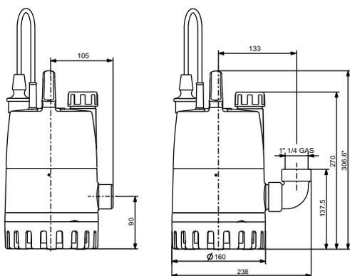
Рис. 3. Габаритные размеры
