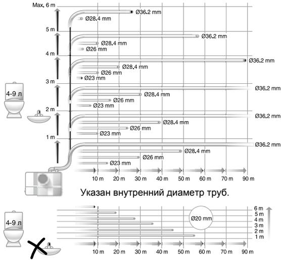
Рис. 55. Максимальная длина вертикальных и горизонтальных сливных труб
