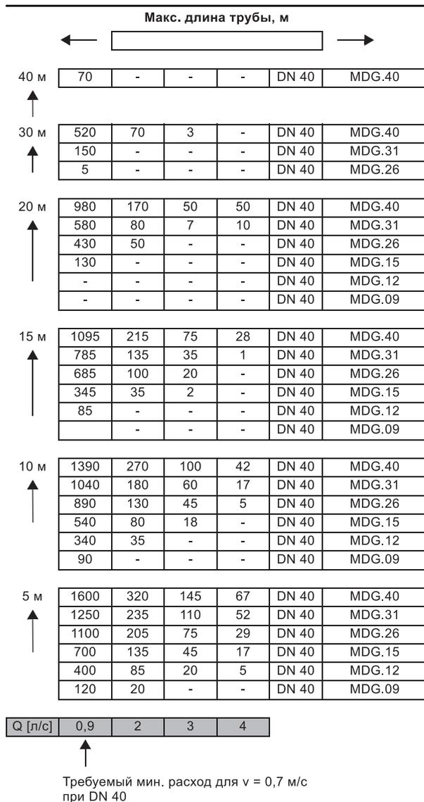
Рис. 104. Максимальная длина вертикальных или горизонтальных напорных трубопроводов
