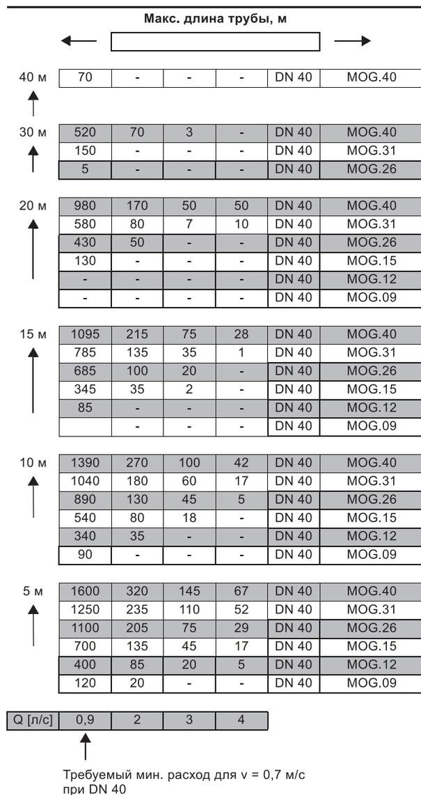
Рис. 90. Максимальная длина вертикальных или горизонтальных напорных трубопроводов
