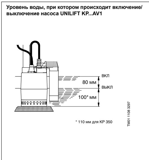
**Примечание.** Допускается монтаж насоса в горизонтальном или наклонном положении. При этом напорный патрубок должен быть расположен в верхней точке, уровень воды – всегда выше приёмной сетки насоса.
