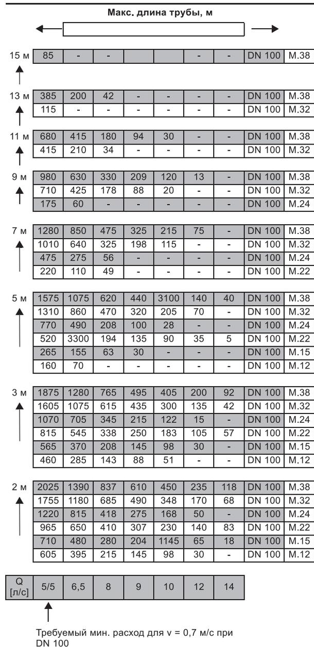
Рис. 100. Максимальная длина вертикальных или горизонтальных напорных трубопроводов
