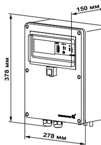
Рис. 120. Габаритные размеры
