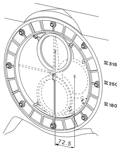
**Рис. 105.** Основное впускное отверстие с эксцентрическим диском
