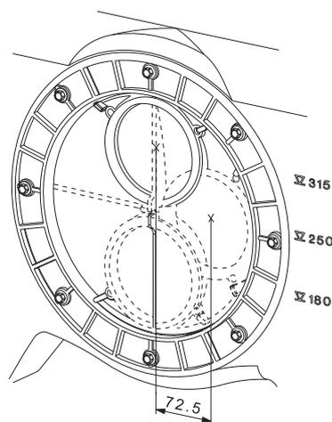
Рис. 96. Основное впускное отверстие с эксцентрическим диском
