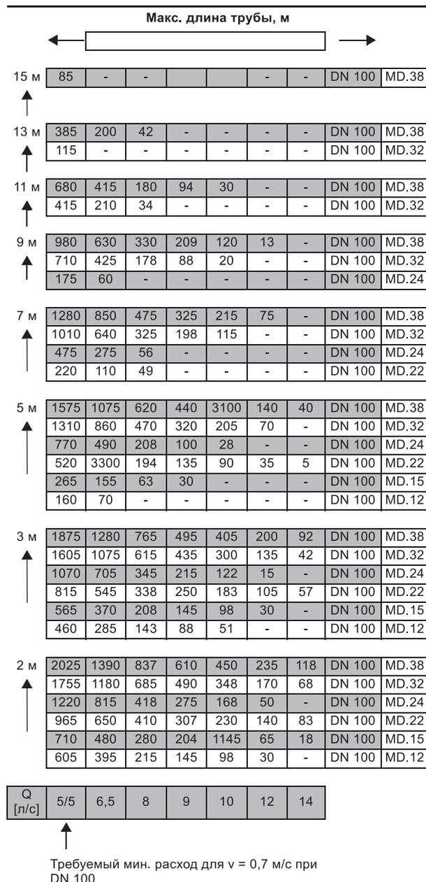
Рис. 95. Максимальная длина вертикальных или горизонтальных напорных трубопроводов
