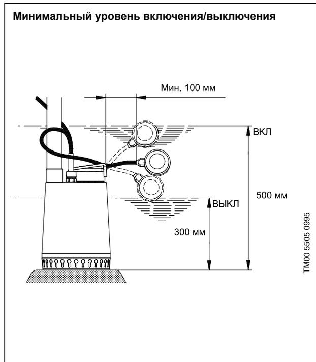
**Примечание.** Допускается монтаж насоса в горизонтальном или наклонном положении. При этом напорный патрубок должен быть расположен в верхней точке, уровень воды – всегда выше приёмной сетки насоса.
