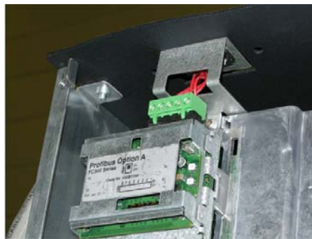
Рисунок 3.52: Подключение шины fieldbus сверху.
