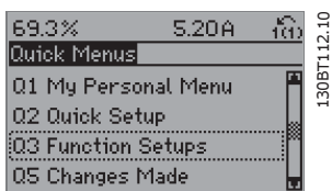
Рисунок 5.4: Шаг3: С помощью навигационных кнопок "вверх"/"вниз" выберите настройку функций. Нажмите [OK].
