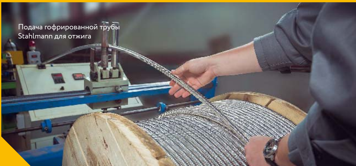
Линия охлаждения гофрированной трубы Stahlmann после отжига
