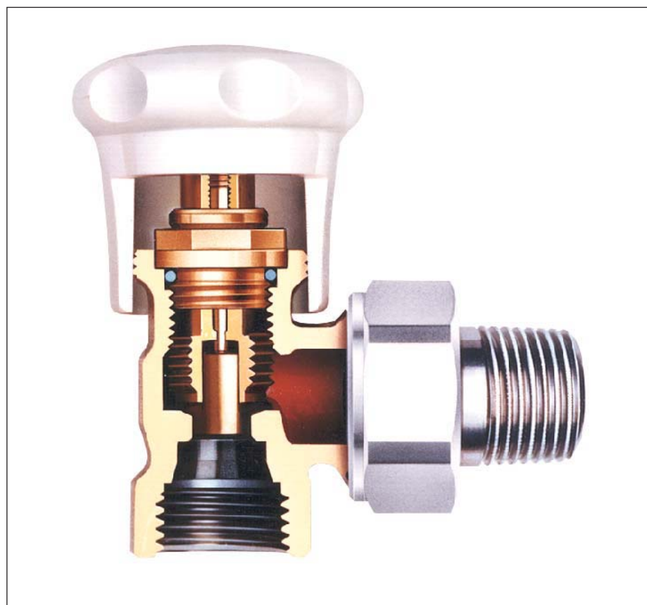
Рис. 11-5. Радиаторный вентиль ГЕРЦ-АС-Т-90 в разрезе
