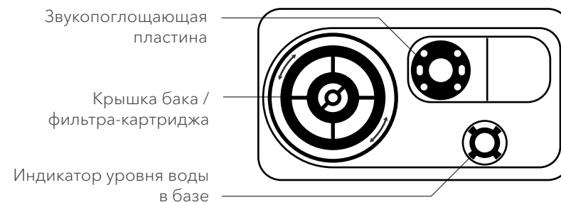
Рис. 2b Устройство бака прибора
