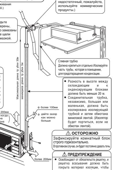
**Проход Стены и Монтаж Защитной Трубки**
