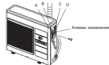
**Проверка электропитания и напряжения**
