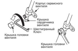
Когда начинается откачка, слегка ослабьте гайку, чтобы проверить, что воздух засасывается. За тем затяните ее.
