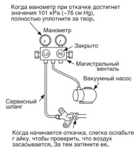
Когда манометр при отсатке достигнет значения 101 кPa (-76 см Hg), полностью уплотните за твoр.
