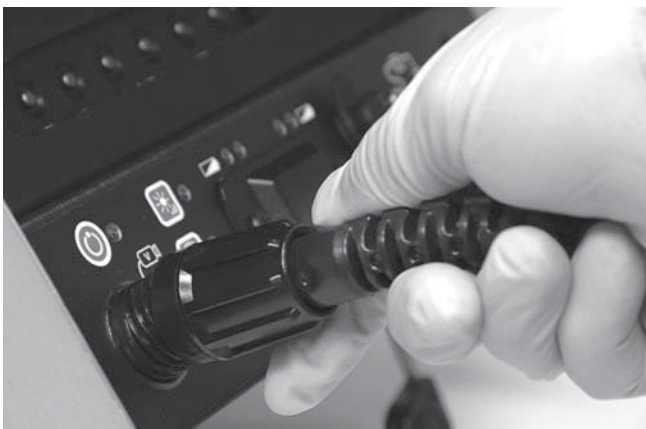
Obrázok 13 – Pripojenie sa na CCU jednotku SeeSnake
