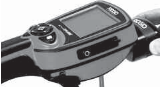
Şekil 10 – microEXPLORER Kamera Monitörü'nün bağlanması
