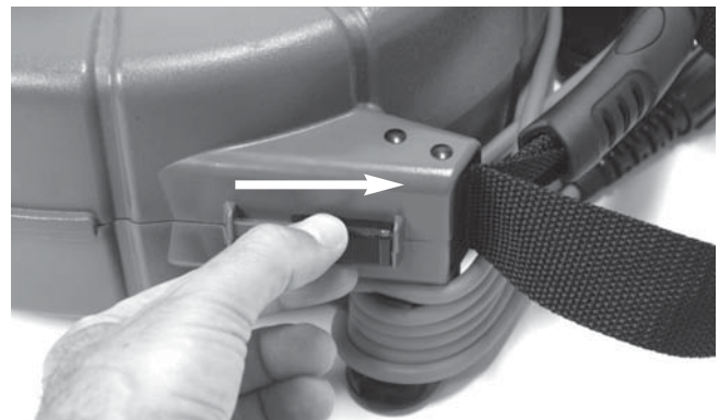
Obrázek 4 – Povolení pouzdra cívky microDrain
