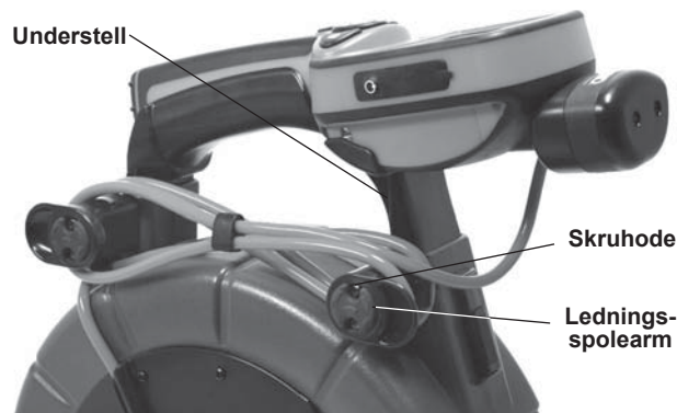
Figur 9 – Understellsstøtte og armer til ledningsspole
