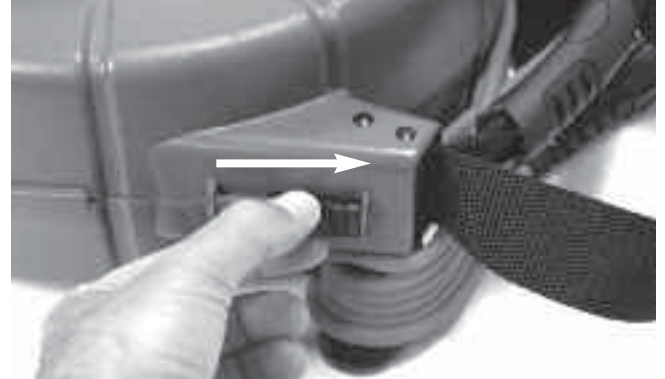
Şekil 4 - microDrain tambur muhafazasının mandallarının açılması
