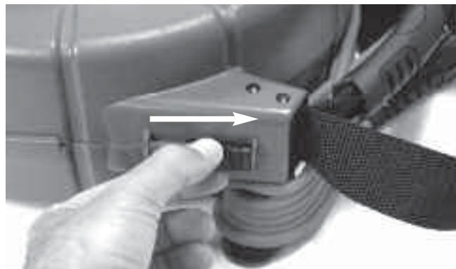
4. kép – a microDrain orsóház megbontása
