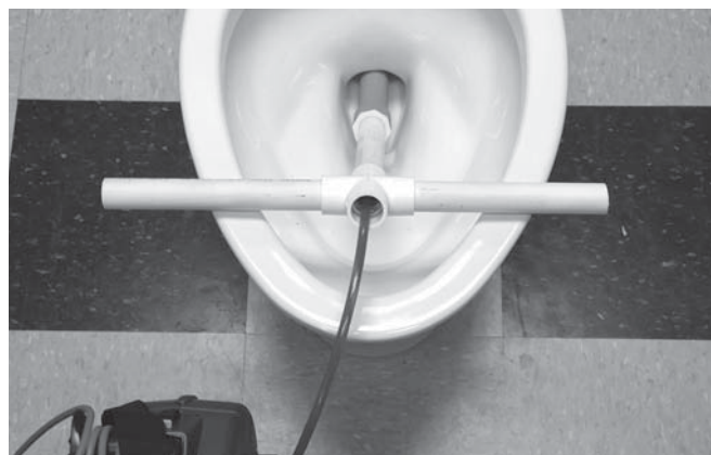
Abbildung 24 – Verwendung eines PVC-Führungsrohrs
