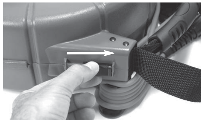
Figur 4 – Lossa spärrarna på microDrain-rullens hölje
