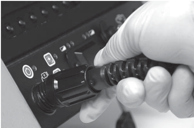
Figur 13 – Koble til en SeeSnake-kamerakontrollenhet
