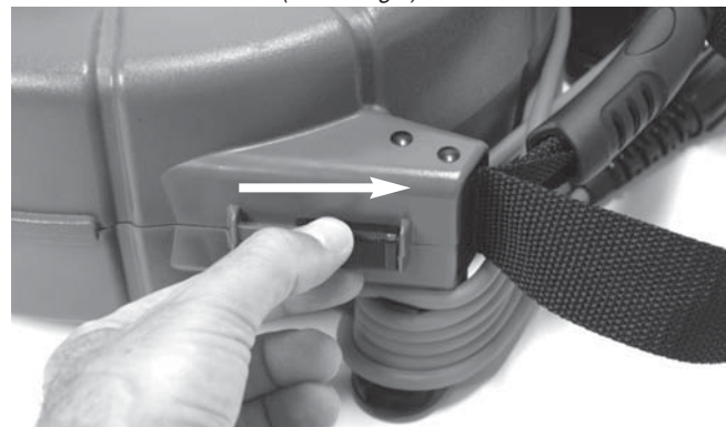
Abbildung 4 – Entriegeln des microDrain Trommelgehäuses
