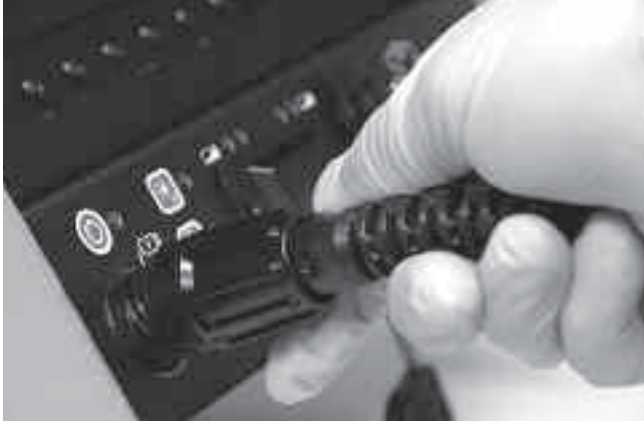
Şekil 13 – Bir SeeSnake CCU ünitesine bağlantı yapılması
