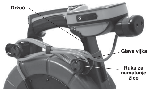
Slika 9 – Nosač držača i ruke za namatanje žice
