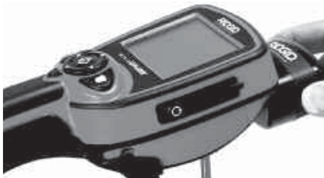
Ilustracja 10 – Podłączenie monitora kamery microEXPLORER
