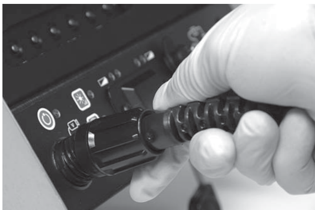
Slika 13 – Priklop na SeeSnake CCU
