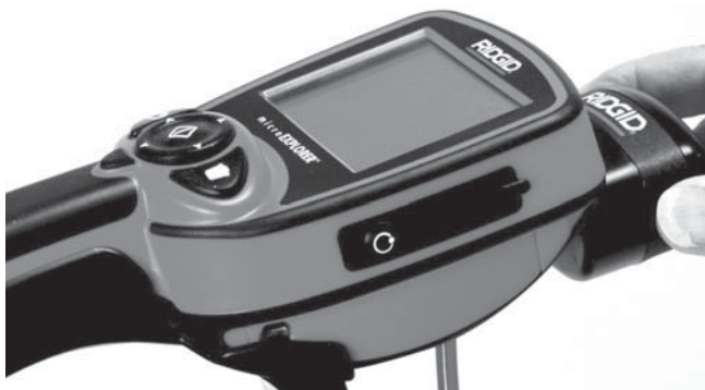
Obrázek 10 – Připojení kamery microEXPLORER
