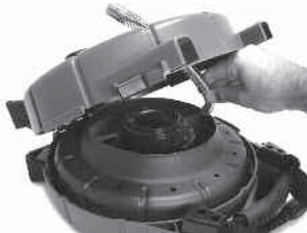
5. kép – Kamerafej kivezetése
