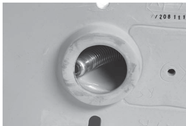
Figur 20 – Kamerahuvudet blockeras i en krök
