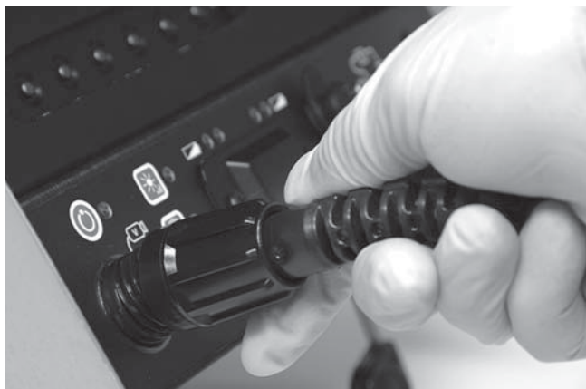
Figur 13 – Anslutning till en SeeSnake-kamerastyrenhet
