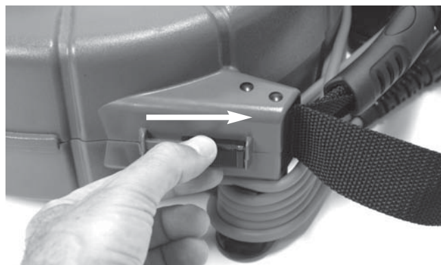
Figur 4 – Løsn låsene på microDrain-rullens hus
