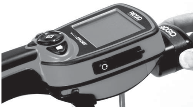
Slika 10 – Priklop monitorja microEXPLORER
