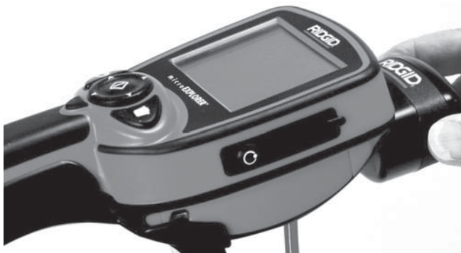
Figura 10 – Ligar o monitor da câmara microEXPLORER
