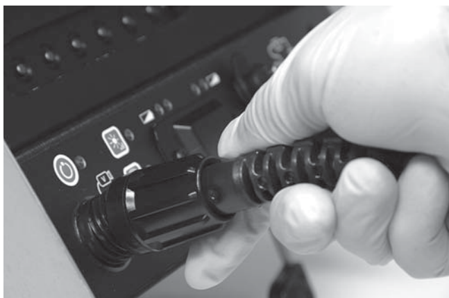
Obrázek 13 – Připojení k jednotce CCU SeeSnake
