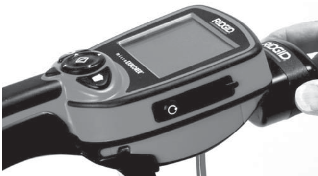
Εικόνα 10 – Σύνδεση του Μόνιτορ Κάμερας microEXPLORER
