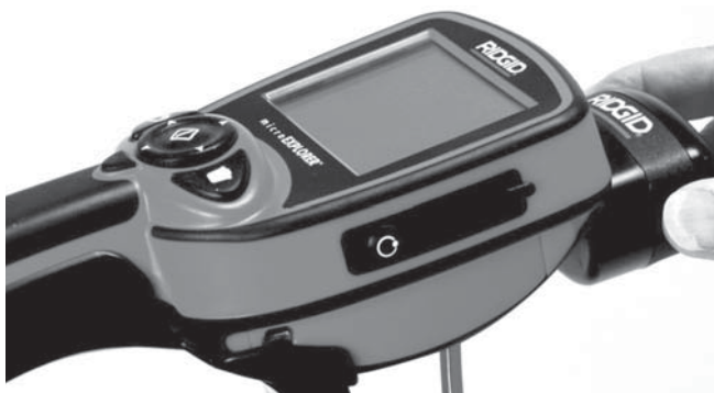
Slika 10 – Spajanje monitora microEXPLORER kamere
