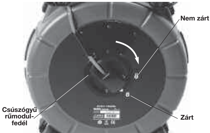
8. kép – A csúszógyűrűs modul fedelének rögzítése
