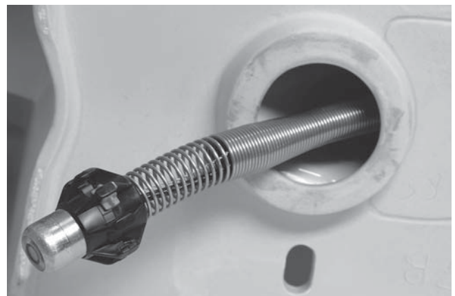
Figura 22 – Cámara que logró pasar la curva
