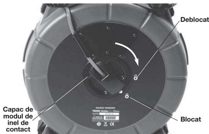
Figura 8 – Blocarea capacului modulului inelului de contact
