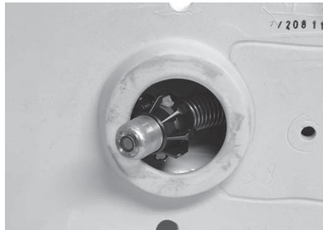
Figur 21 – Kamerahodet med styreball i en sving
