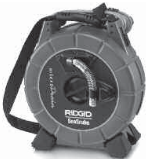
Ilustracja 6 – Prawidłowo poprowadzona głowica kamery
