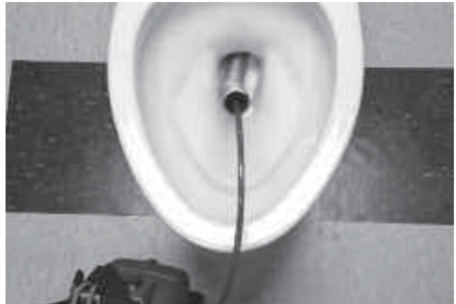
Şekil 25 – Esnek Kılavuz Boru Kullanımı
