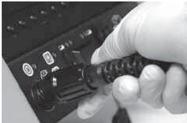
Ilustracja 13 – Podłączanie do CCU SeeSnake
