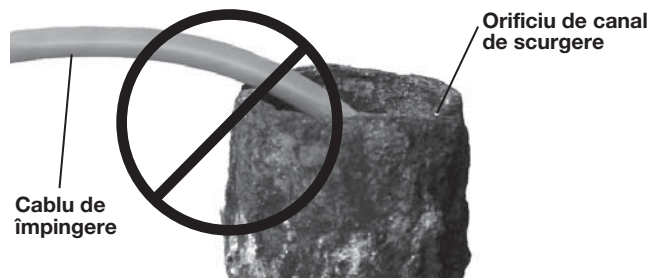
Figura 18 – Nu trageți cablul la colțurile ascuțite
