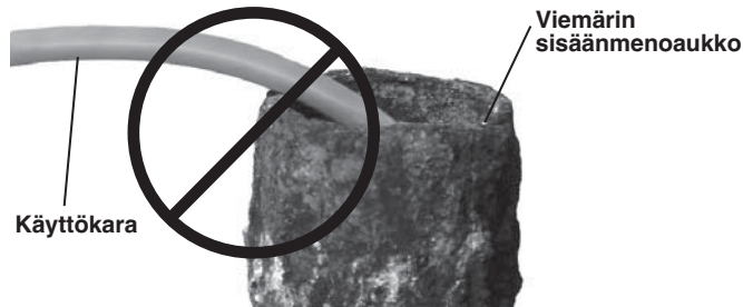
Kuva 18 – välttä vetämistä terävissä kulmissa
