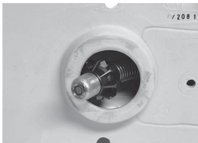
Figur 21 – Kamerahoved med kuglestyr i en drejning
