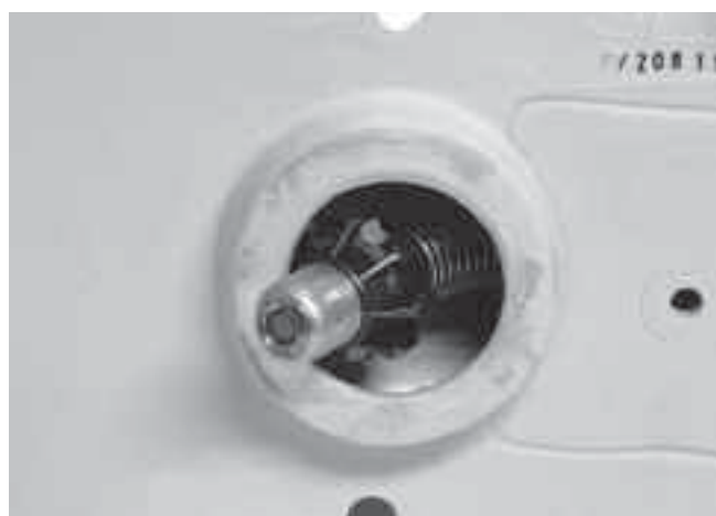
Ilustracja 21 – Głowica kamery z przewodnikiem kulowym na zakręcie
