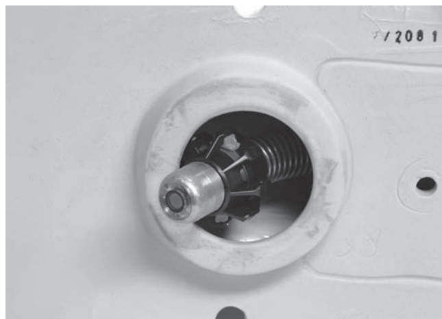
Εικόνα 21 – Κεφαλή κάμερας με σφαίρα οδηγό σε γωνία
