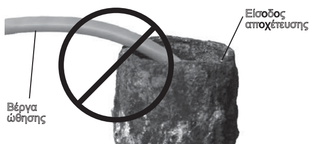
Εικόνα 18 – Αποφύγετε το τράβηγμα στις οξείες γωνίες
