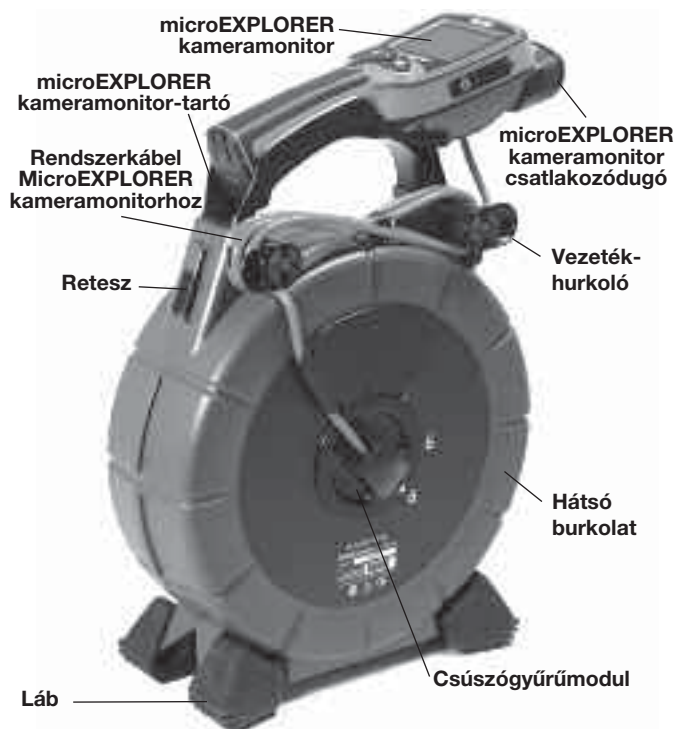
2. ábra: Hátulnézet (microEXPLORER kameramonitor-konfiguráció)
