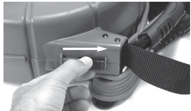
Figura 4 – Sbloccare il vano della ruota microDrain
