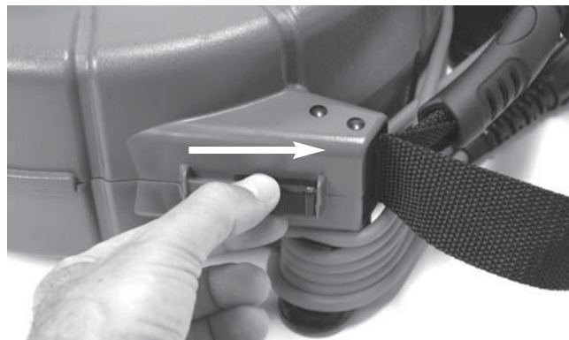
Figura 4 – Destrançar a bobina na caixa da bobina do microDrain
