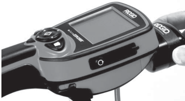
Figur 10 – Koble til microEXPLORER-kameraskjermen
