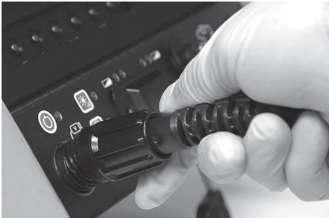
Figura 13 – Collegamento a un video CCU SeeSnake
