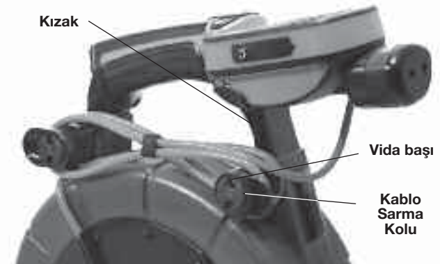
Şekil 9 - Kızak Desteği ve Kablo Sarma Kolları
