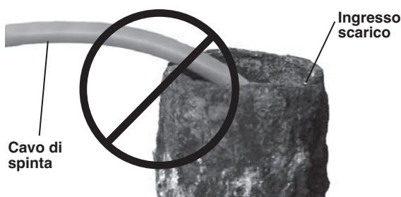
Figura 18 – Evitare di tirarlo contro angoli affilati
