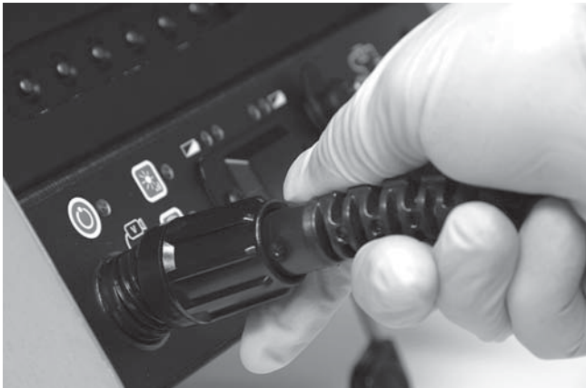
Slika 13 – Spajanje na SeeSnake CCU
