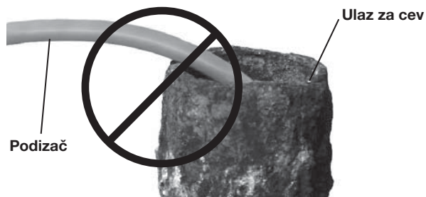
Slika 18 – Izbegavajte povlačenja pod oštrim uglom
