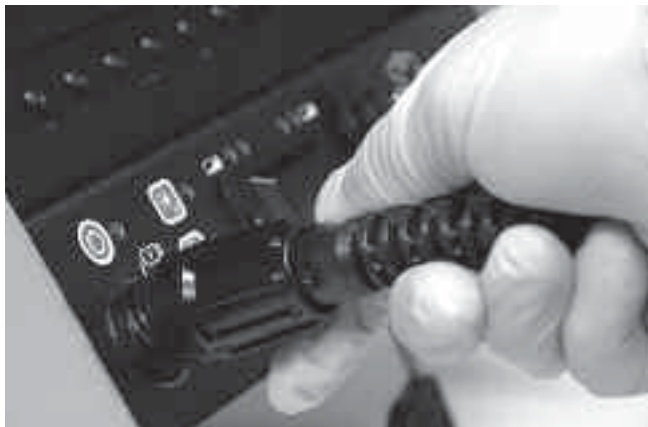
13. ábra: Csatlakoztatás a SeeSnake CCU egységéhez
