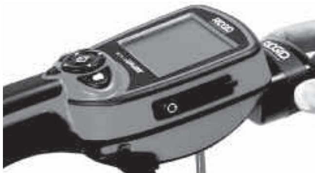
10. kép – A microEXPLORER kijelző csatlakoztatása
