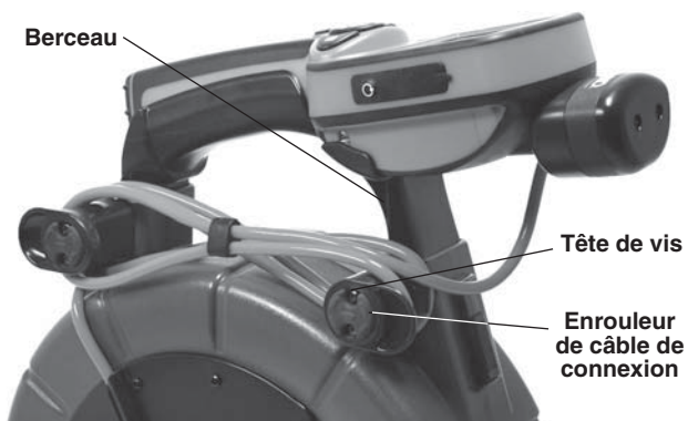
Figure 9 – Berceau et enrouleurs de câble de connexion
