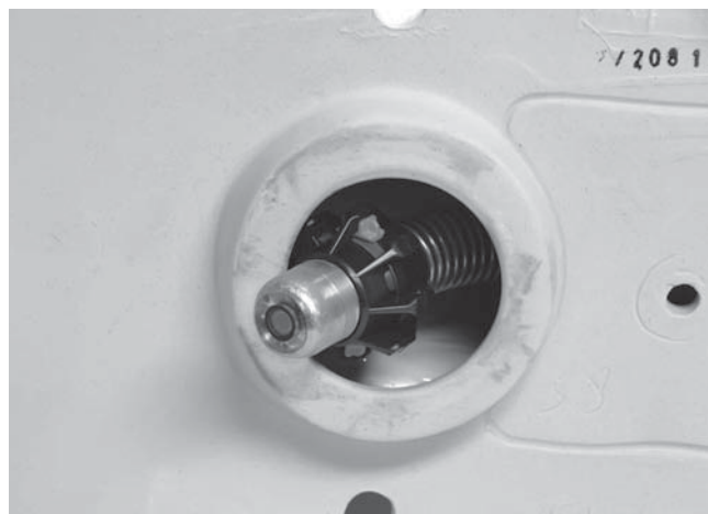
Slika 21 – Glava kamere s kuglastom vodilicom pri zakretanju
