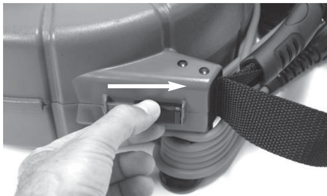
Slika 4 – Otvaranje “microDrain” kućišta sa koturom
