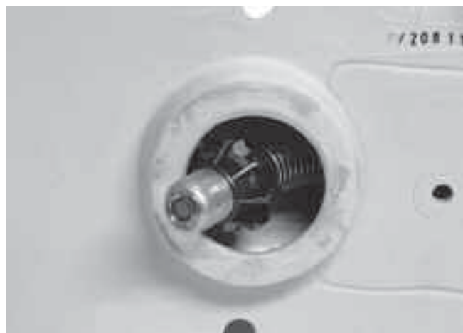
21. ábra: Kamerafej vezetógömbbel a fordulóban
