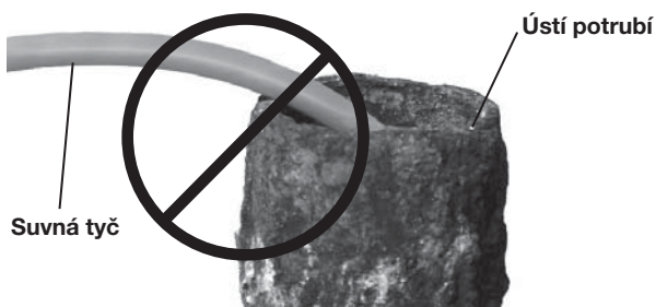
Obrázek 18 – U ostrých úhlů postupujte opatrně.
