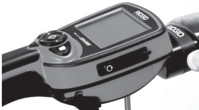
Figura 10 – Forma en que se conecta la cámara-monitor microEXPLORER al sistema
