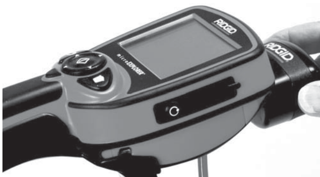
Obrázok 10 – Pripájanie monitoru kamery microEXPLORER
