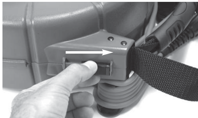
Kuva 4 – microDrain-kelan laatikon avaaminen
