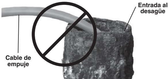
Figura 18 – Evite raspar el cable contra bordes afilados
