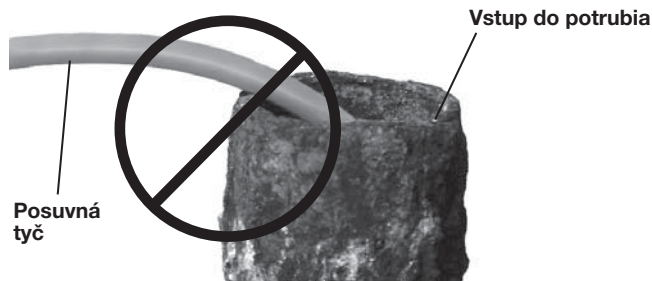
Obrázok 18 – Vyhýbajte sa ťahaniu za ostrými uhlami.
