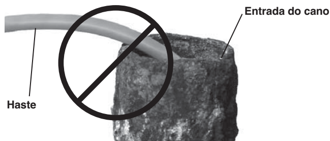
Figura 18 – Evite puxar em curvas apertadas
