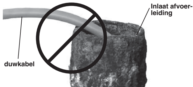
Figuur 18 – Niet in scherpe hoeken trekken
