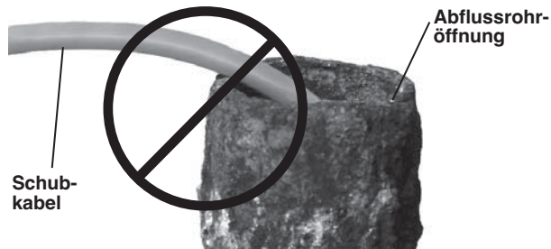
Abbildung 18 – Nicht im spitzen Winkel ziehen
