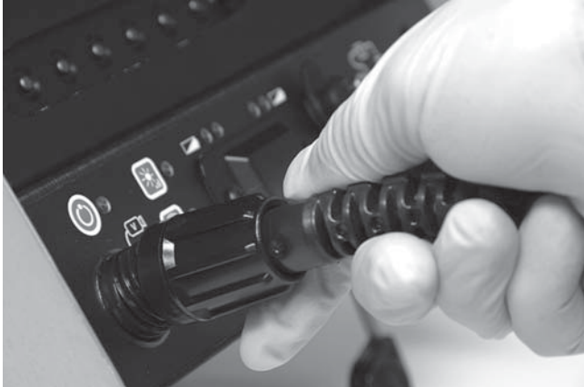
Εικόνα 13 – Σύνδεση σε μονάδα SeeSnake CCU
