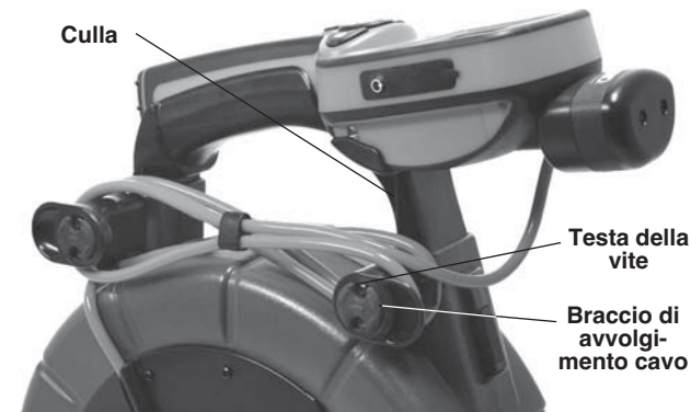
Figura 9 – Supporto culla e bracci di avvolgimento cavo
