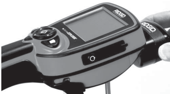
Figur 10 – Sådan tilslutter du microEXPLORER-kameraskærmen
