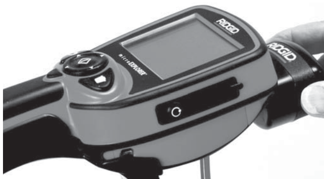
Figura 10 – Conectarea monitorului videoreceptorului microEXPLORER
