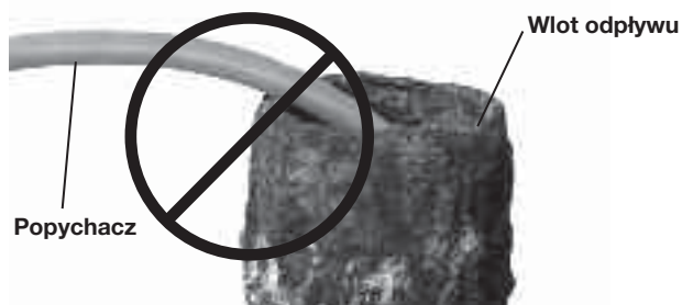
Ilustracja 18 – Unikać ciągnięcia pod ostrymi kątami
