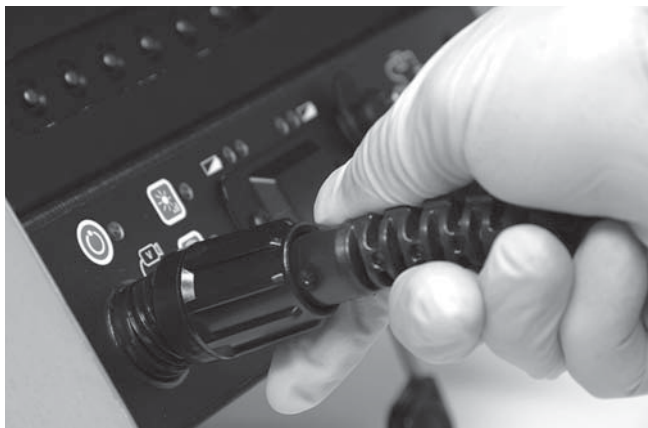
Figuur 13 – Aansluiten op een SeeSnake-CCU
