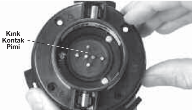
Şekil 7 - Kırık Kontak Pimi
