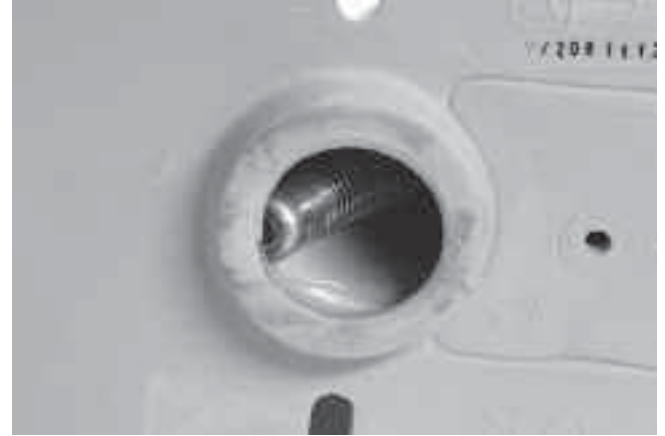
Şekil 20 – Dönüşte Engellenen Kamera Kafası
