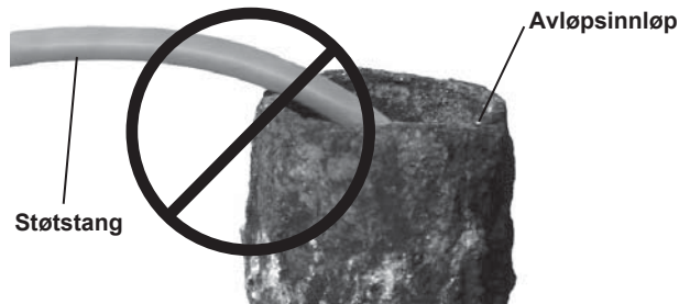
Figur 18 – Unngå å trekke den over skarpe kanter
