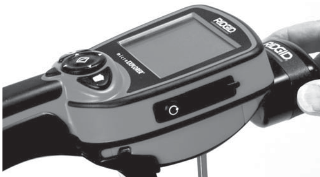
Figur 10 – Anslutning av microEXPLORER-kameraskärmen
