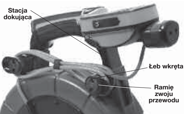
Ilustracja 9 – Wspornik stacji dokującej i ramiona zwoju przewodu
