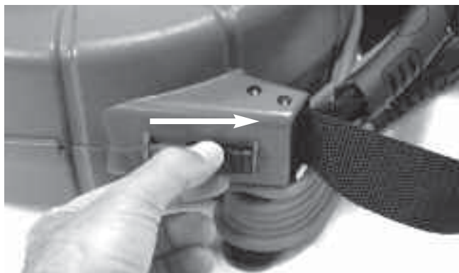
Ilustracja 4 – Otwieranie obudowy szpuli microDrain
