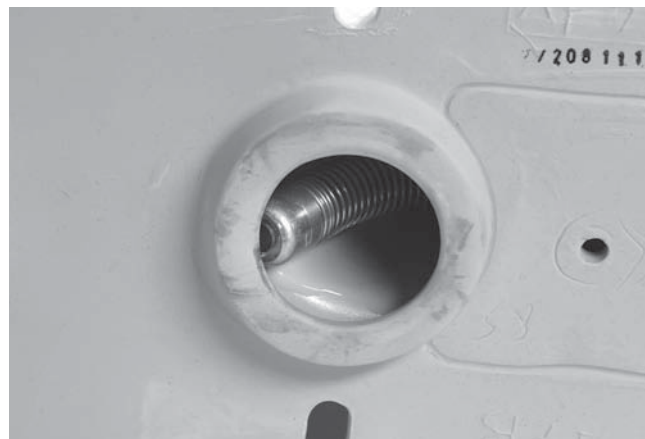
Figura 20 – Cabeça da câmara bloqueada num ângulo
