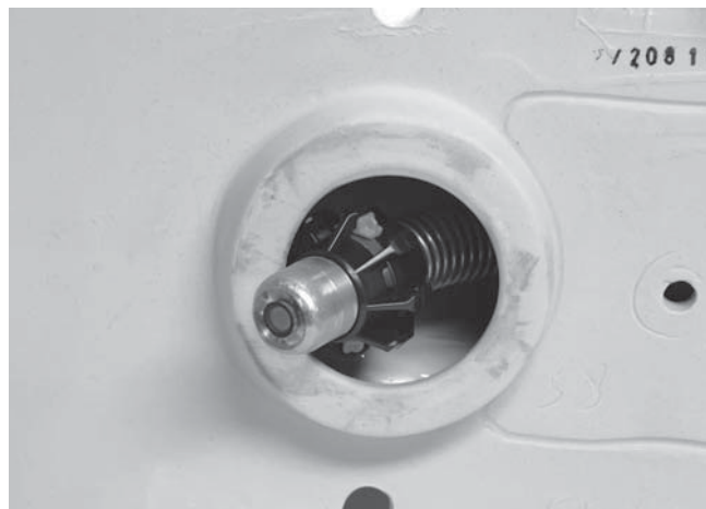
Figure 21 – Tête de caméra équipée d'une boule de guidage
