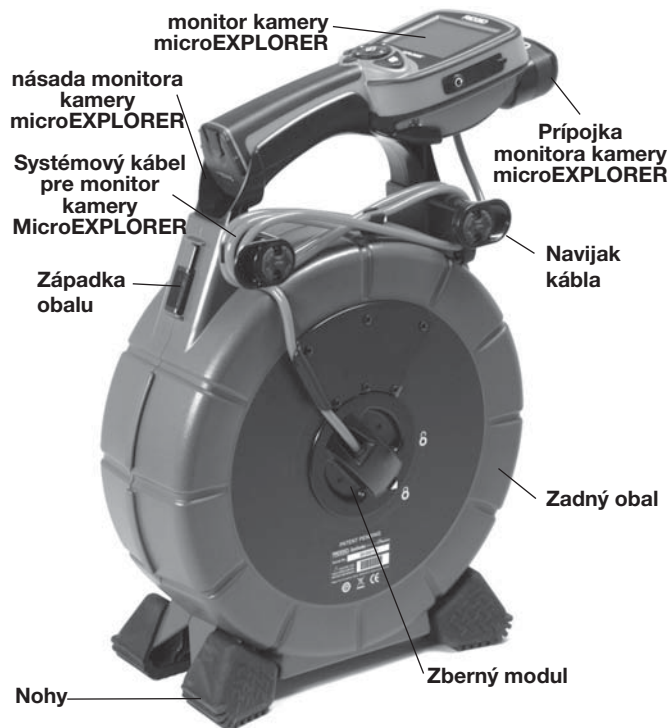
Obrázok 2 – Pohľad zozadu (nastavenie monitora kamery microEXPLORER)
