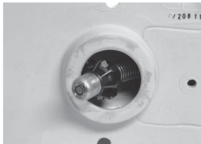
Kuva 21 – kamerapää ja kuulaohjain käännöskohdassa
