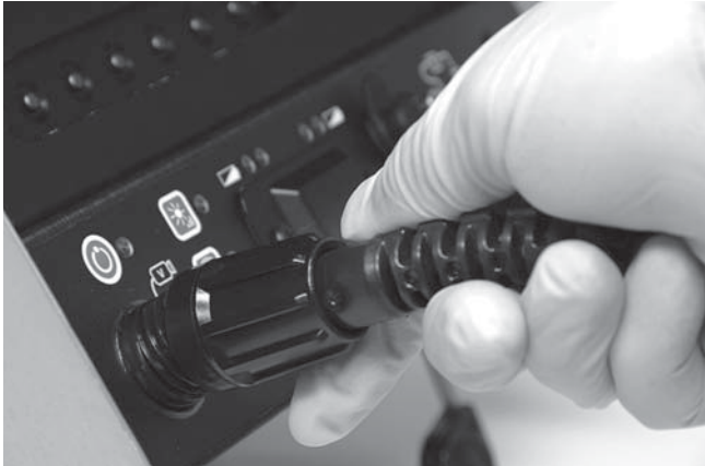
Abbildung 13 – Anschließen an eine SeeSnake CCU
