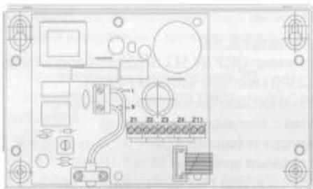
Снять верхнюю крышку и установленный заводом кабель. Фазовые кабели пролегть через отверстия на дне и подключить к клеммам L и N. В каждой клемме умещаются 2 кабеля. Устройство не должно заземляться. Смонтировать верхнюю крышку.
