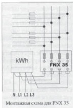
Для установки в домах предпочтительно смонтировать основной фильтр FPX 35/ FNX 35 между счетчиком и распределителем, т.е. на шлейфе счетчика.
