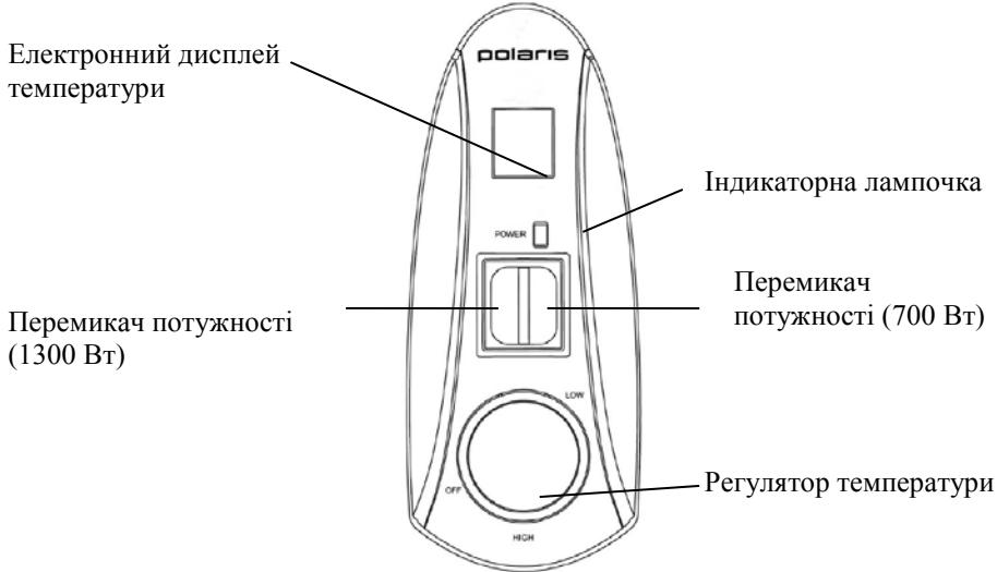
1. За допомогою перемикачів потужності встановіть необхідну потужність (700Вт /1300Вт /2000Вт). Від вибору потужності залежить швидкість (час) нагрівання води до заданої температури.
