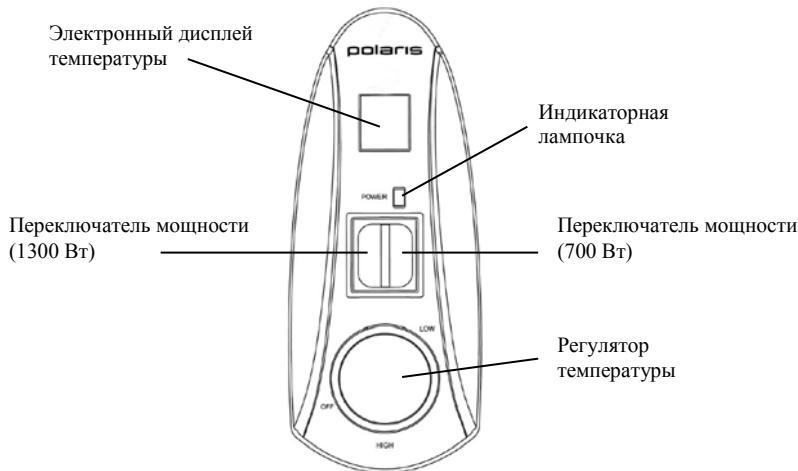
1. С помощью переключателей мощности установите необходимую мощность (700Вт /1300Вт /2000Вт). От выбора мощности зависит скорость (время) нагрева воды до заданной температуры.
