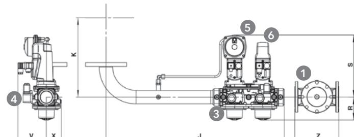
Газовая рампа полностью установлена, имеет все электрические подключения и протестирована (электрически, гидравлически и на герметичность)
