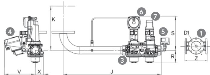
Газовая рампа полностью установлена, имеет все электрические подключения и протестирована (электрически, гидравлически и на герметичность)
