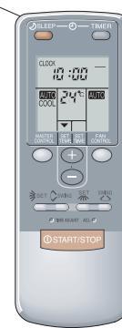
1. Инициация режима задания кода выполняется удерживанием клавиши MASTER CONTROL нажатой в течение 5 секунд.
