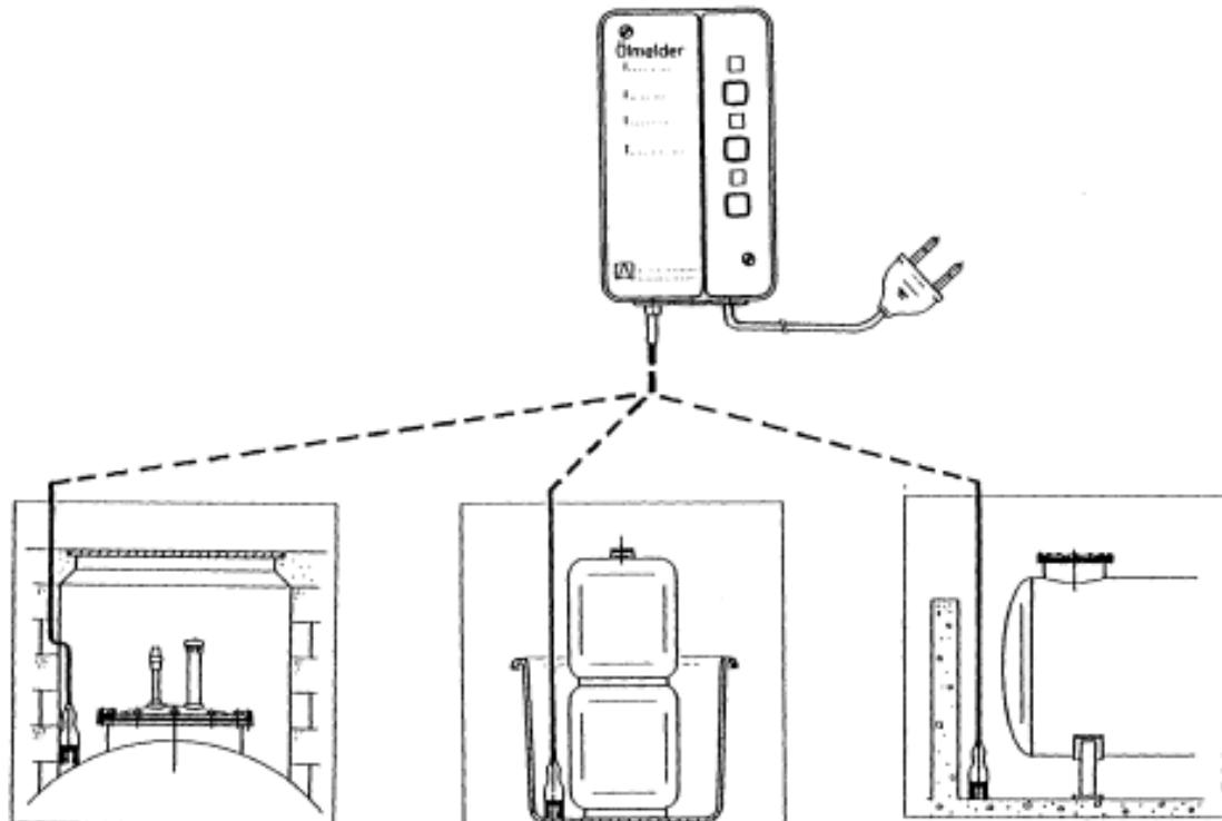
2. Датчик топлива, масла с системой передачи сообщений для дистанционного оповещения об утечке Афризо:
