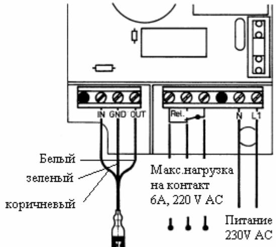
Электропитание: В комплект поставки датчика топлива, масла OM1 входит также провод и штекер. Для включения датчика топлива, масла OM1 вставьте штекер в розетку.
