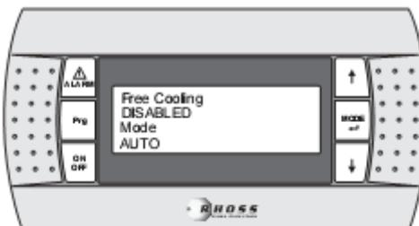
Нажмите кнопку **MODE**, затем (на экране должна появиться надпись ENABLED (ВКЛЮЧЕН)) для включения функции. Снова нажмите кнопку **MODE** и
