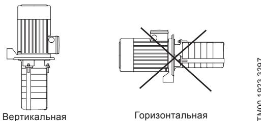
**Рис. 30** Установка насоса МТН
