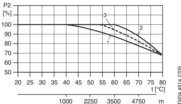
Рис. 4 Максимальная мощность двигателя зависит от температуры окружающей среды и высоты над уровнем моря.
