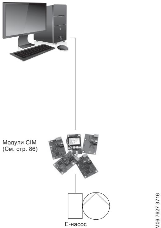
Рис. 11 Структура центральной системы управления
