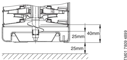
**Рис. 31** Минимальный зазор между насосом и баком
