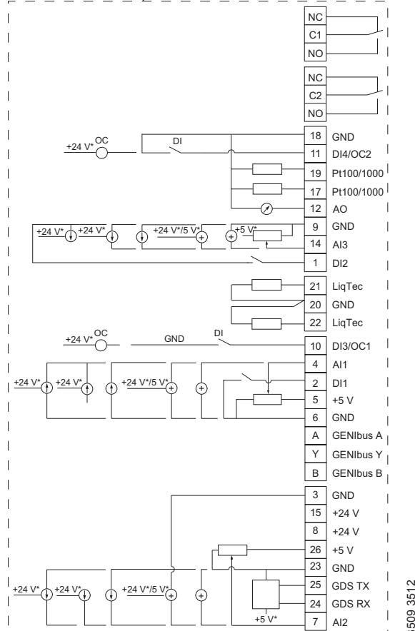
\* При использовании внешнего источника питания в наличии должно иметься соединение с заземлением.
