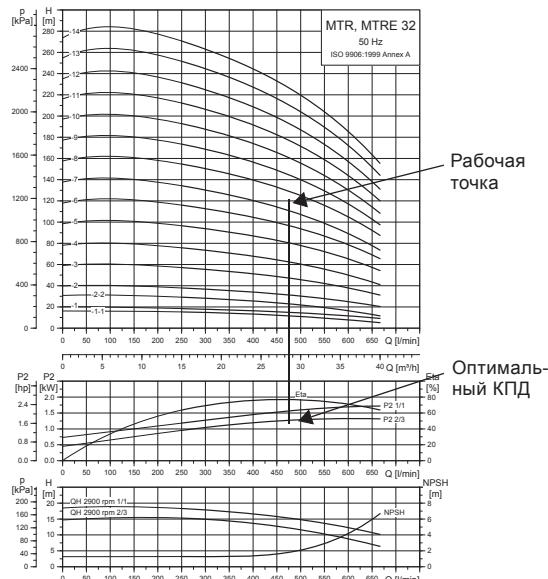
Рис. 39 Пример рабочей точки насоса MTR
