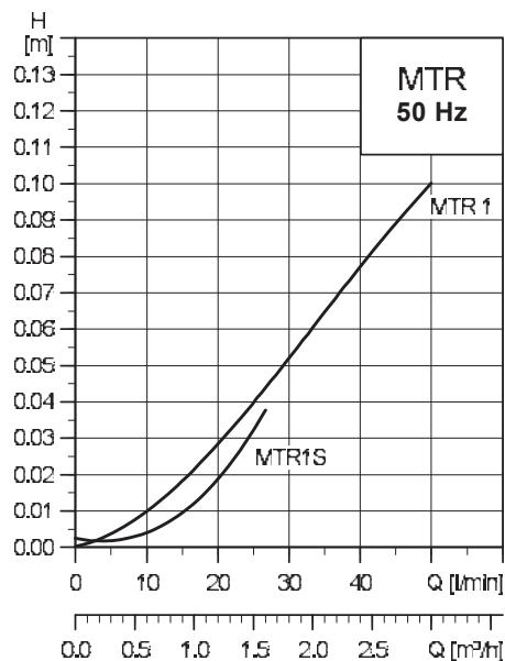
**Рис. 44** Потери давления при перекачивании жидкости через пустую камеру для насосов MTR 1s и MTR 1.
