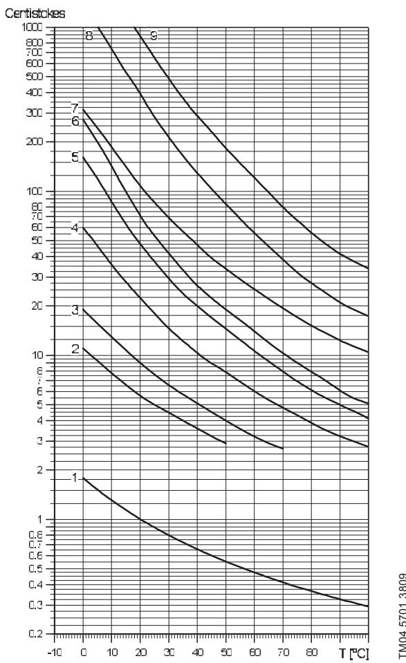
**Рис. 48** Кинематическая вязкость разных масел в зависимости от температуры масла
