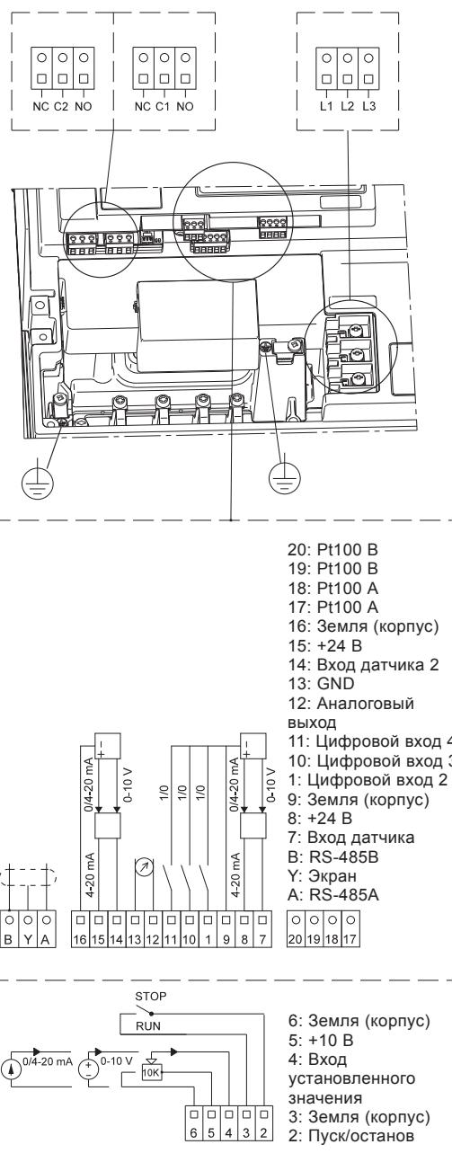
Рис. 16 Клеммы соединений, расширенный модуль ввода/вывода
