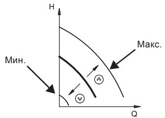
Рис. 13 Режим работы с постоянной характеристикой
