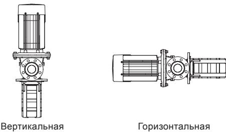
**Рис. 25** Установка насосов MTR, MTRE
