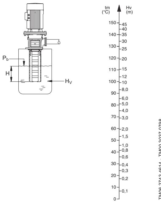
**Рис. 49** Минимальное давление на входе - NPSH
