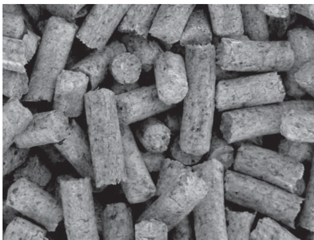
Рис. 18 – некачественные древесные pellets – темные, с примесью коры (с черными вкраплениями)
