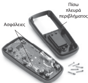
Εικόνα 9 – Αφαίρεση πίσω πλευράς του περιβλήματος πολυμέτρου
