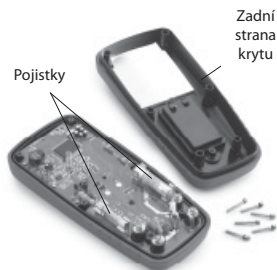
Obrázek 9 – Odstranění zadní strany krytu multimetru
