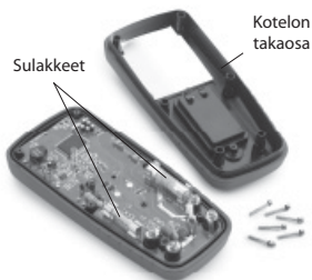
Kuva 9 – Yleismittarin kotelon takaosan irrotus
