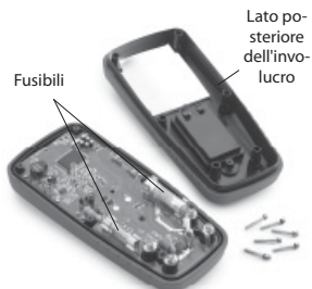
Figura 9 – Rimozione del retro dell'involucro del Multimetro
