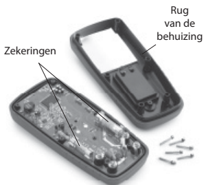
Figuur 9 – De rug van de multimeterbehuizing afnemen
