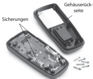
Abbildung 9 – Entfernen der Rückseite des Multimeter-Gehäuses
