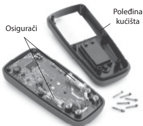
Slika 9 – Uklanjanje pozadine kućišta univerzalnog mernog instrumenta
