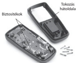
9. ábra – A multiméter tokozása hátoldalának levétele
