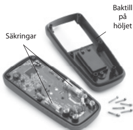
Figur 9 – Demontering av multimeterns baksida
