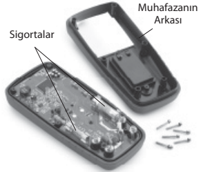
Şekil 9 – Multimetre Muhfazasının Arkasının Çıkartılması
