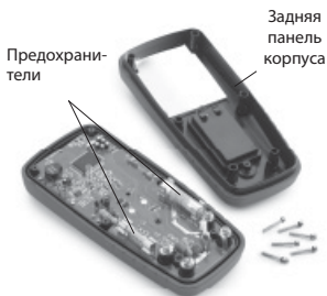
Рис. 9 – Снятие задней панели корпуса
