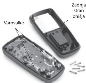
Slika 9 – Odstranjevanje zadnje strani ohišja multimetra
