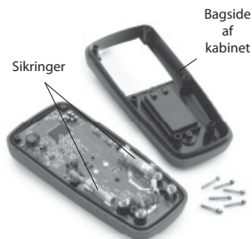
Fig. 9 – Fjernelse af bagsiden af multimeterkabinettet
