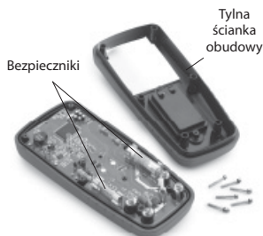
Rys. 9 – Zdejmowanie tylnej ścianki multimetru
