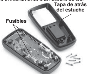
Figure 9 – Extracción de la tapa de atrás del multímetro
