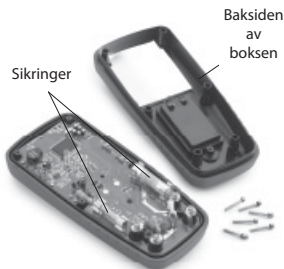
Figur 9 – Fjern baksiden på multimålerdekslet
