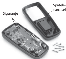
Figura 9 – Scoaterea spatelui carcasei multimetrului
