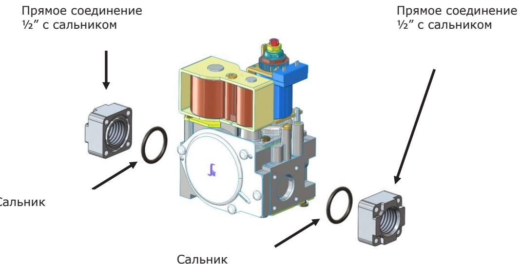
Для того чтобы заменить контроллер пламени, выполните следующие действия: ослабьте винт (который фиксирует контроллер с клапаном). Как только он будет отделен от клапана-тела, просто отсоедините разъём (крепежный винт разъёма), и отсоедините контроллер пламени от проводки.
