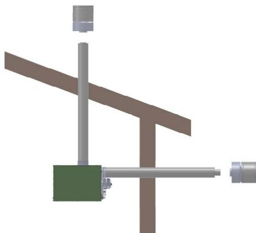
Модели EUGEN – S40, S50, S60 и S115 имеют фиксированное положение коаксиальной системы с горизонтальным вариантом.
