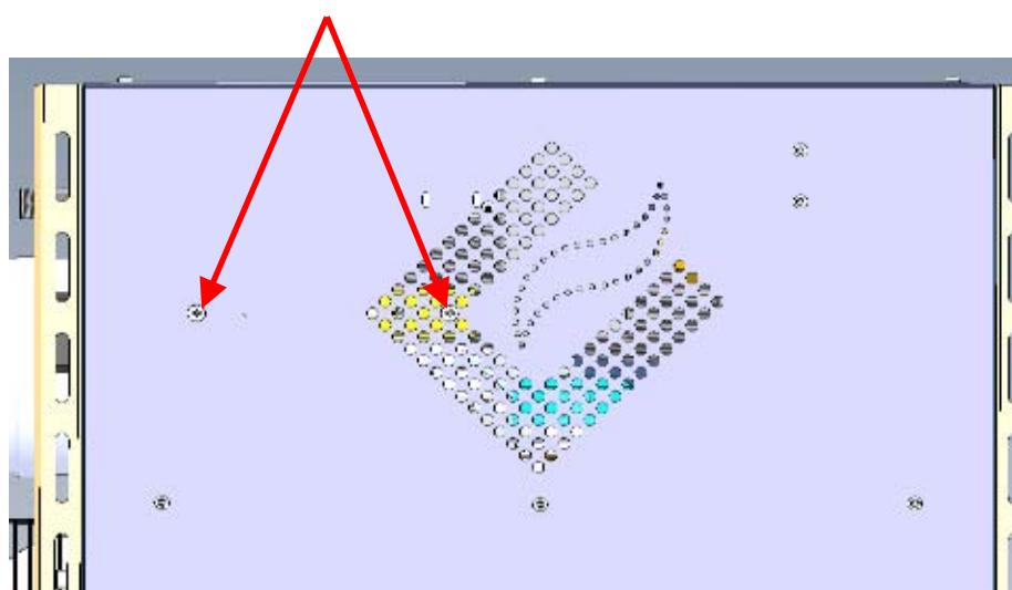
Точки крепления рейки фланцевыми гайками M6.
