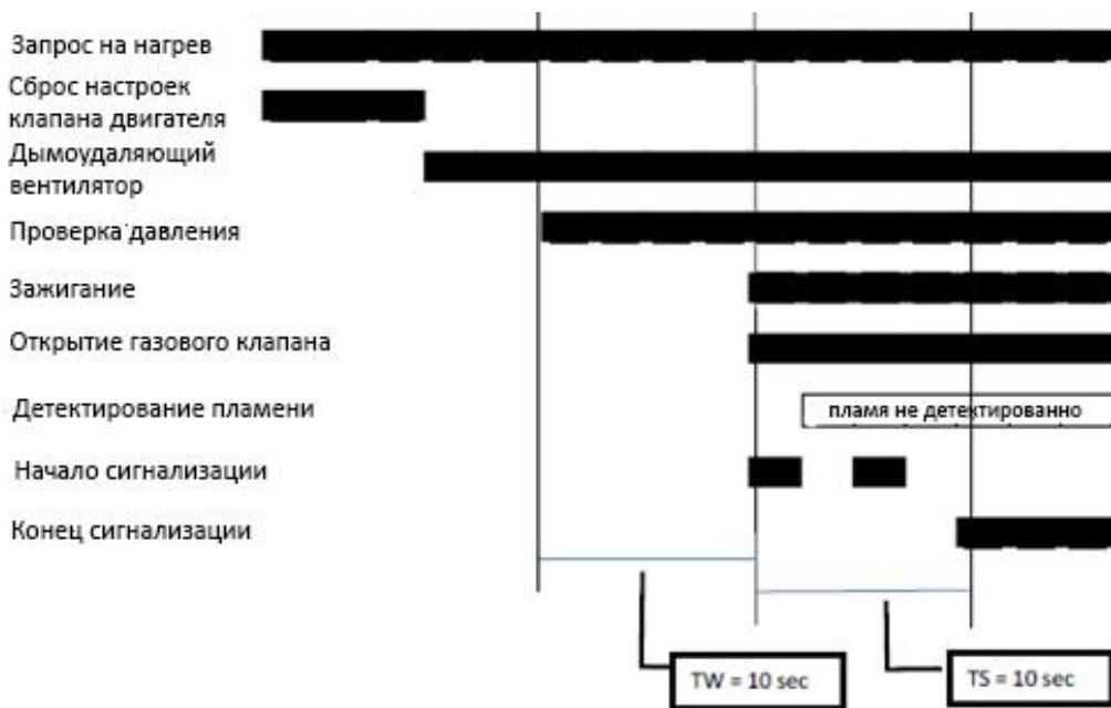
Удостоверившись в том, что теплогенератор заблокировался, в соответствии с диаграммой, откройте газовый кран, разблокируйте теплогенератор путем отключения и повторного включения электропитания. Затем, проверьте правильность его запуска в соответствии с функциональной диаграммой ниже.
