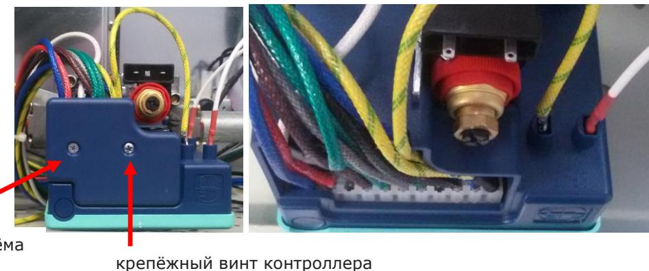
крепёжный винт разъёма
