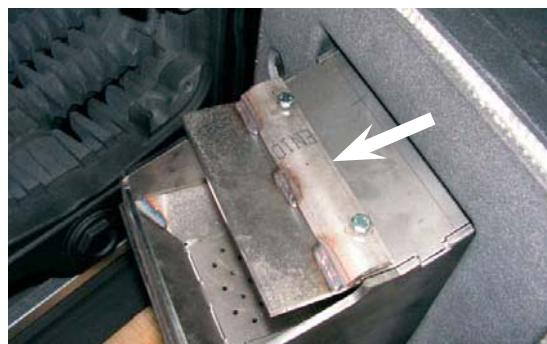
Рис. 13.12: Установка дефлектора пламени
