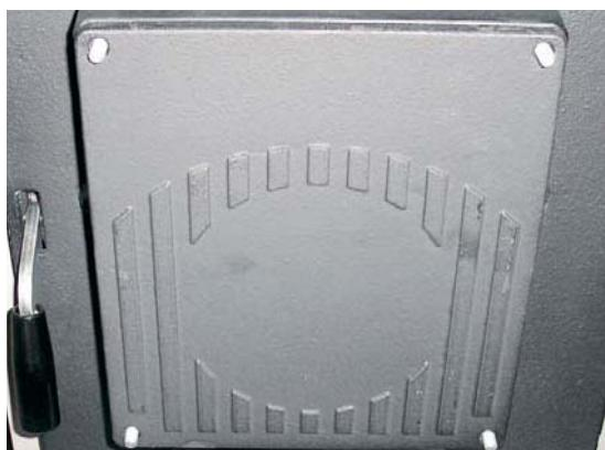
Рис. 13: Снятие глухого фланца
