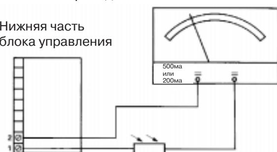
Установка амперметра для постоянного тока, диапазон измерения до 200 мА !
