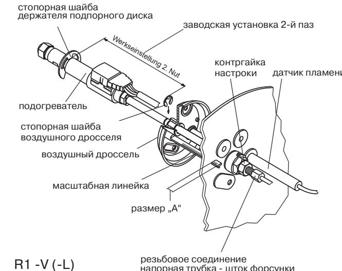
Для R1 (-L): Проверить положение стопоров для подпорного диска и воздушного дросселя. Первый паз позади форсунки предназначен для угла распыления 45°, паз за ним - для 60°. (Заводская установка 45°)
