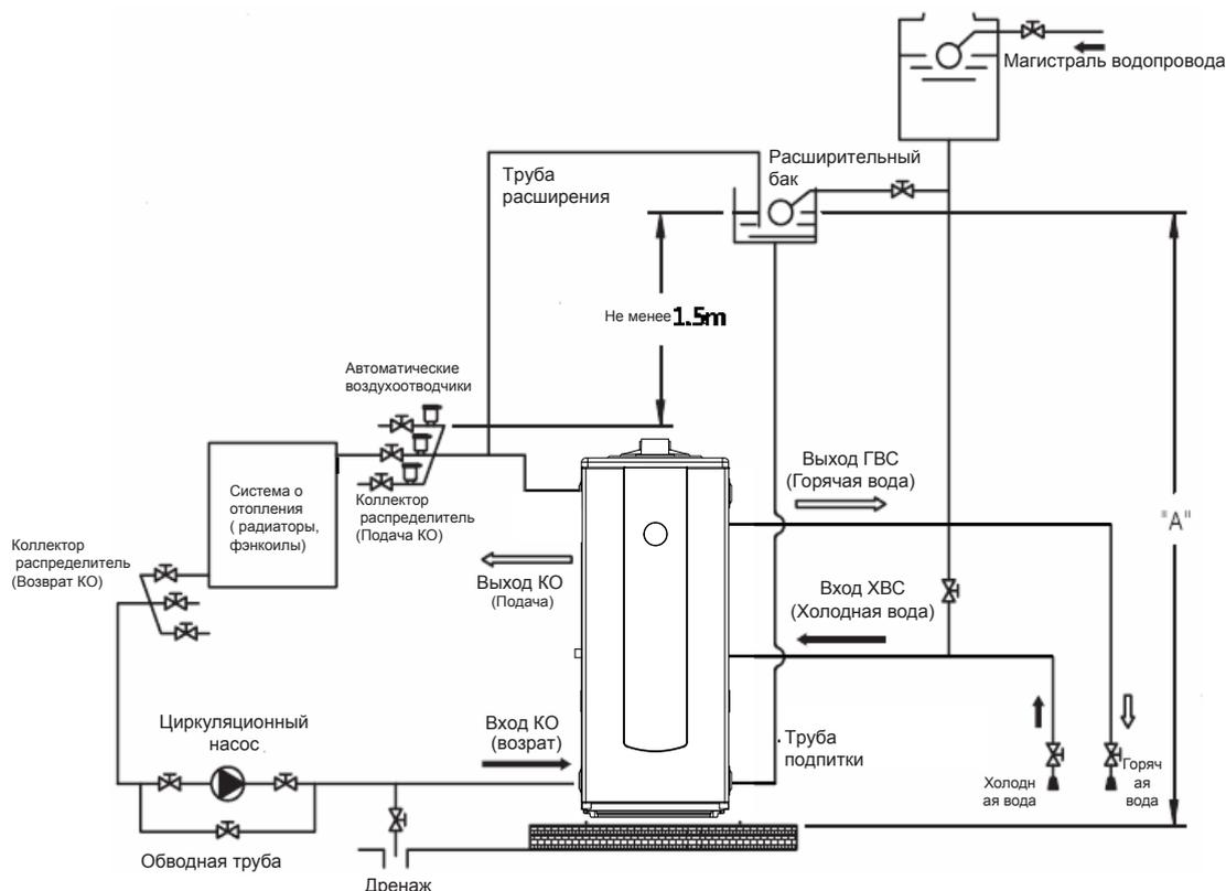
Рисунок 17. Схема подключения котла в открытой системе отопления.
