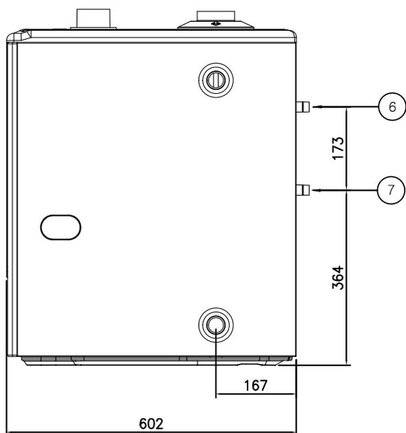
Рисунок 12. Габаритные и присоединительные размеры для STSG-13/17/21
