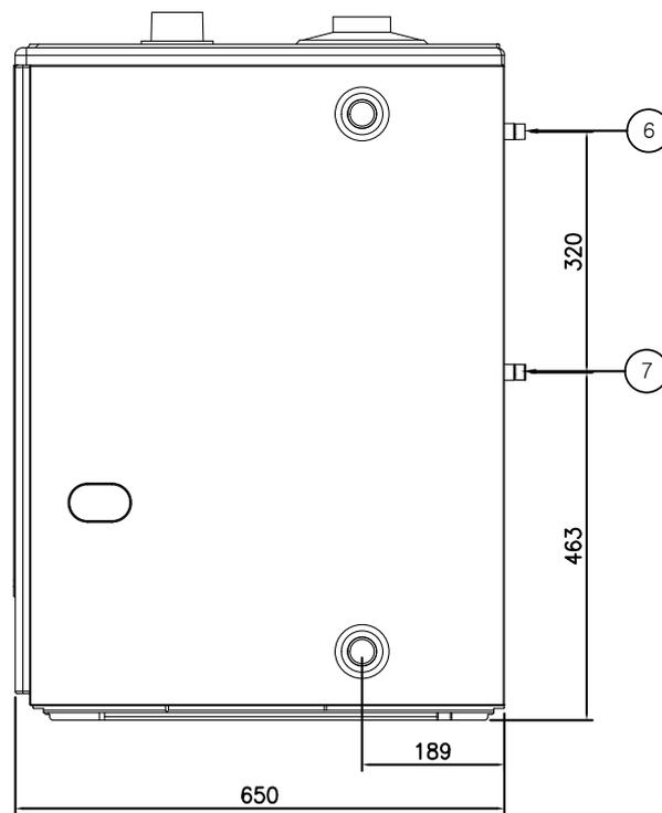
Рисунок 13. Габаритные и присоединительные размеры для STSG-25/30
