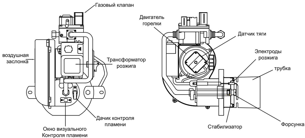
Рисунок 4. Устройство и назначение основных частей горелок для котлов STSG-25/30
