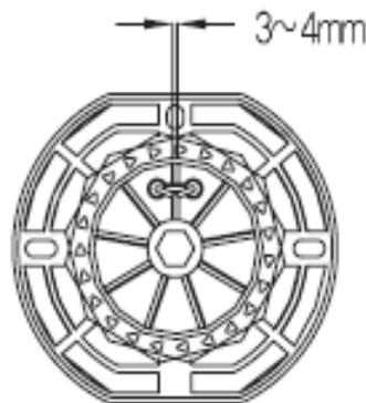
Рисунок 21. Схема регулировки системы поджига
