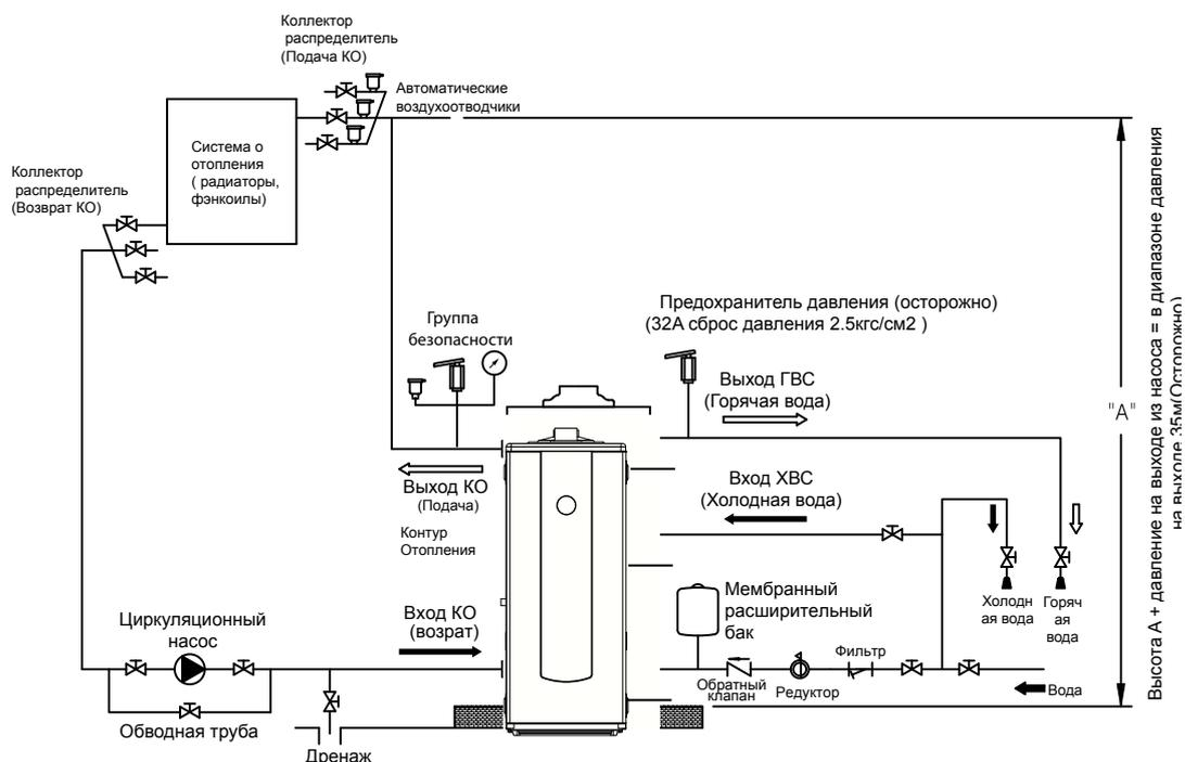
Рисунок 16. Схема подключения котла в закрытой системе отопления.
