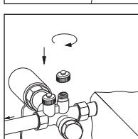
6. По окончанию отсоединить шланг и инструмент для заполнения и слива и снова закрутить защитный колпачок.
