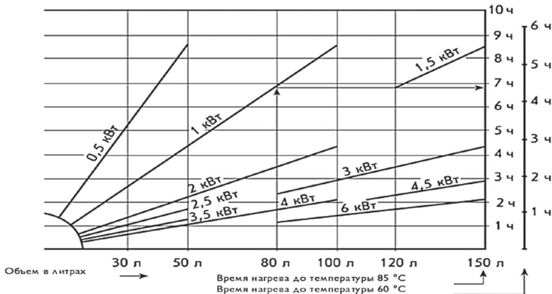
Пример: Прибор 80 л, мощность 1 кВт
