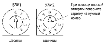
Поворотные переключатели внешнего блока (SW)
