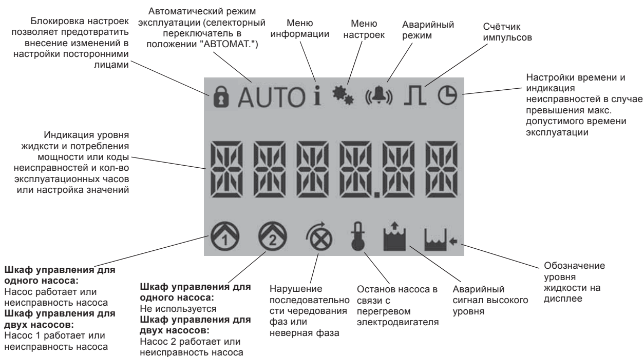
Рис. 39 Панель управления шкафов для установок с одним насосом
