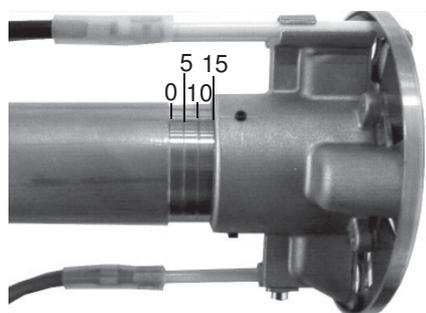
Позиция смесительного устройства зависит от потребной мощности горелки и устанавливается по таблице стр. 14.
