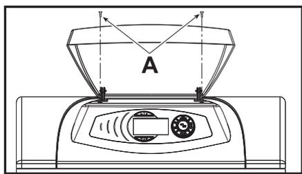
рис. 15 - Доступ к клеммной коробке котла
