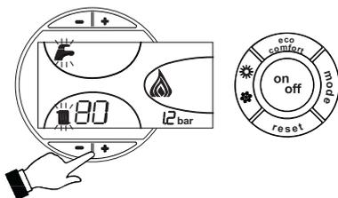
рис. 16 - Режим TEST
