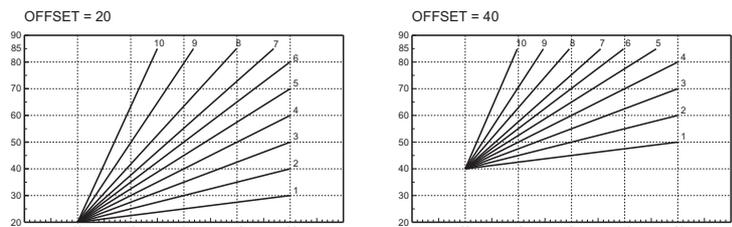
рис. 12 - Пример параллельного смещения кривых погодозависимого регулирования
