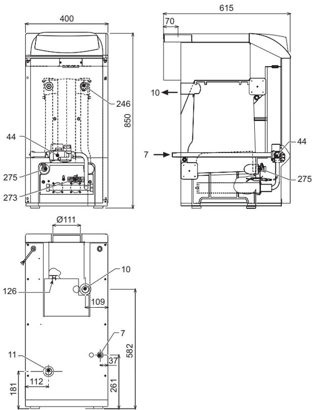
рис. 22 - Габаритные размеры и присоединения мод. \_20;
