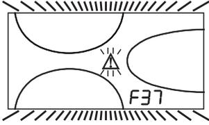
рис. 13 - Недостаточное давление воды в системе отопления
