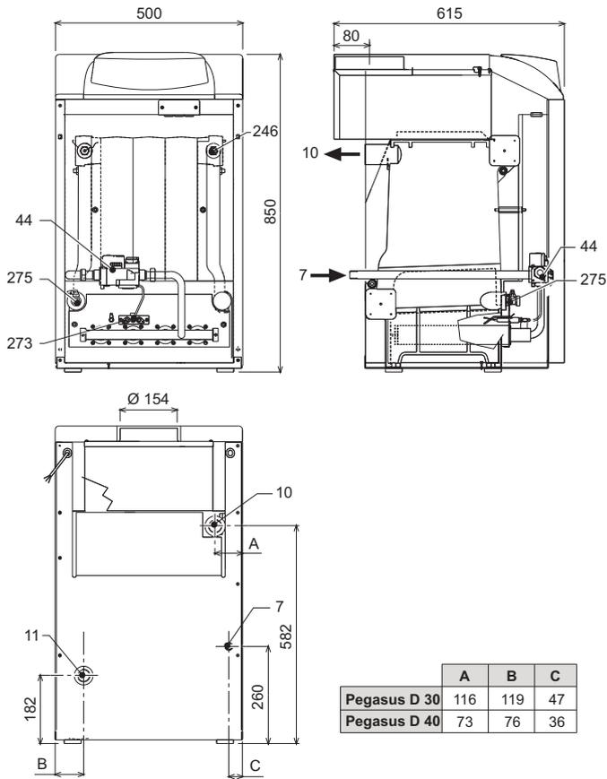
рис. 23 - Габаритные размеры и присоединения мод. \_30-40;
