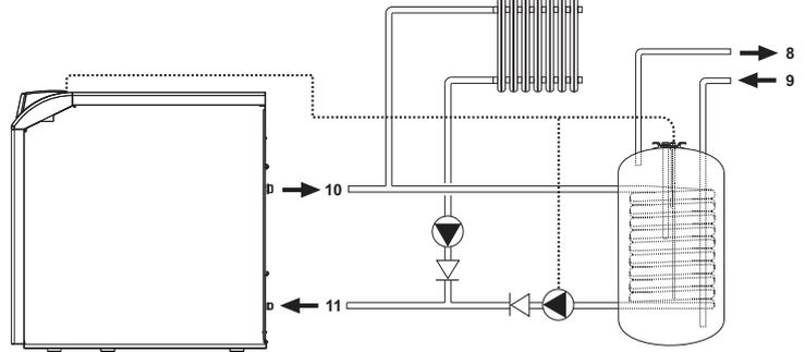
рис. 14 - Схема соединений с внешним бойлером
