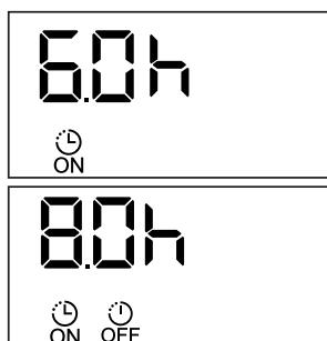
Таймер устанавливается для включения через 6 часов от текущего времени
