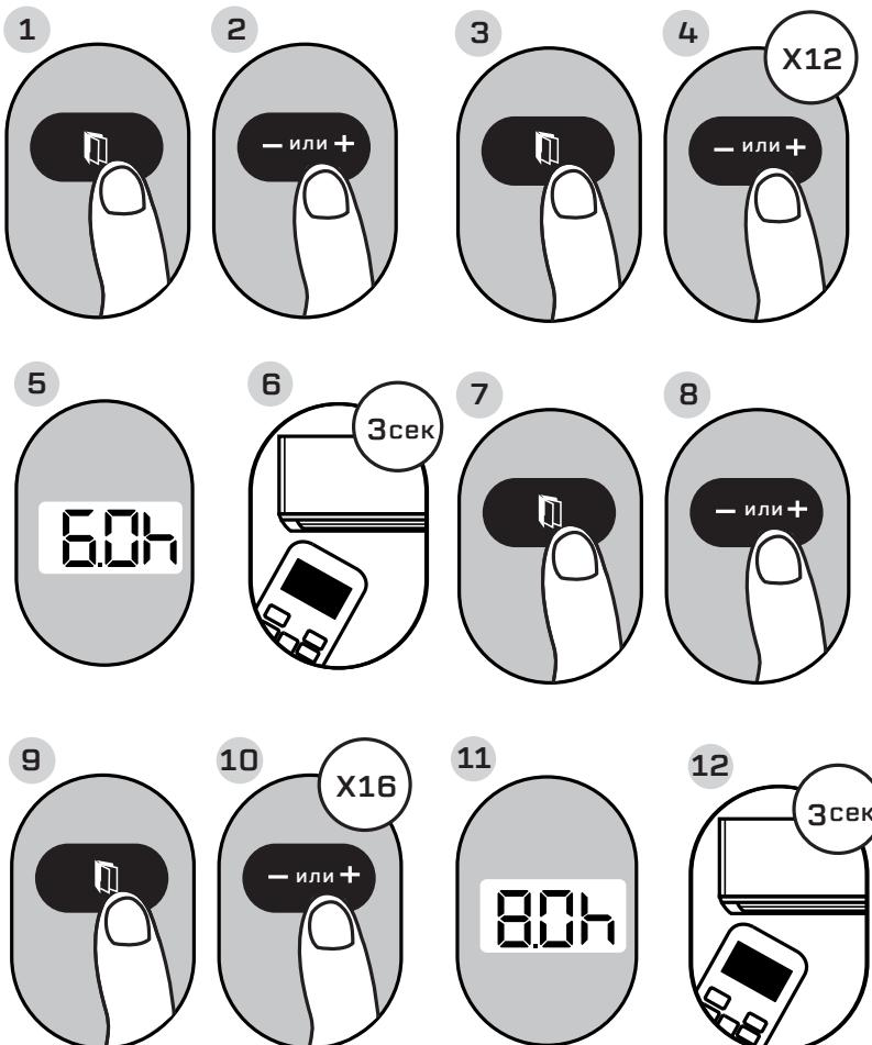
Например: установка таймера на включение через шесть часов работы, рабочее время два часа и затем автоматическое выключение.
