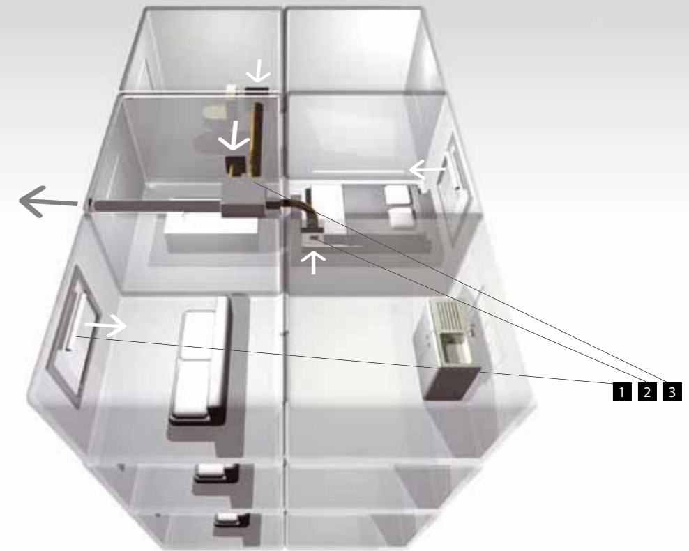
1. Приточные устройства. 2. Вытяжные устройства. 3. Вентилятор
