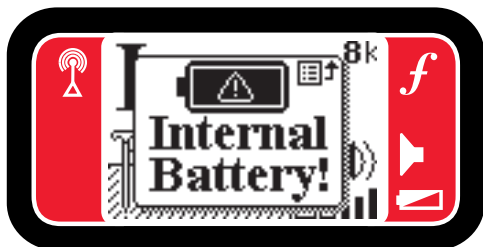
Рисунок 5 – Предупреждение о внутренней батарее
