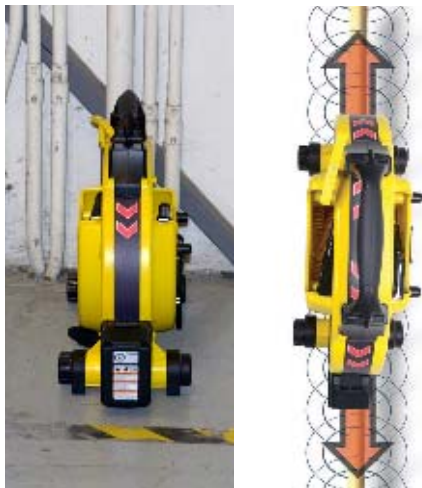
Рисунок 12 – Ориентировочные стрелки, выравненные вдоль проводника
