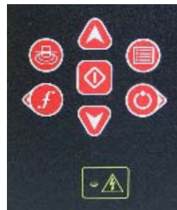
Рисунок 4 – Светодиод Индикатор высокого напряжения
