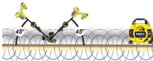
Рисунок 14 – Проверка на наличие воздушной связи
