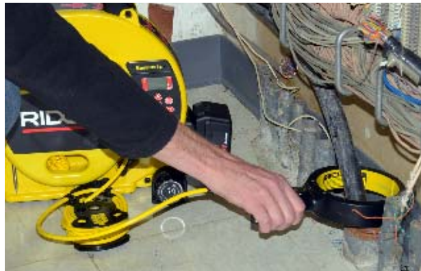
Рисунок 11 – Индукционный зажим в использовании
