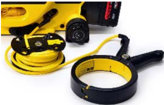
Рисунок 10 – ST-33Q+ с индукционным зажимом
