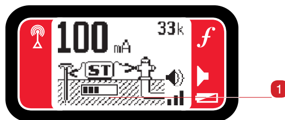
Рисунок 8 – Индикаторная полоса значения силы тока
