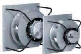
Для подачи охлажденного воздуха в помещение через нижнюю или верхнюю часть прецизионного кондиционера используются центробежные вентиляторы либо осерадиальные вентиляторы "Plug Fun" с ЕС-мотором. Преимуществом ЕС-моторов является существенное энергосбережение совместно с точным регулированием расхода воздуха в соответствии с характеристикой сети воздуховодов.
