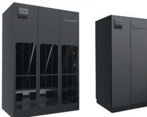
**LSP-CWK** – прецизионные кондиционеры холодопроизводительностью от 12-89 кВт, работающих по схеме с водоохлаждаемым теплообменником от источника с холодной водой. Теплообменник изготовлен из медных труб, оребренных алюминиевыми ламелями. Воздушный фильтр класса очистки EU4.
