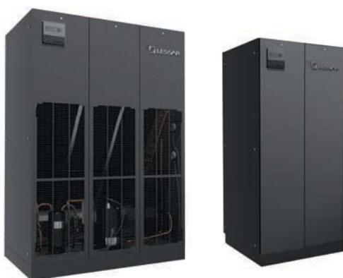
**LSP-BXK** – тип прецизионных кондиционеров холодопроизводительностью от 7-60 кВт, работающих по схеме с выносным воздухоохлаждаемым конденсатором. Воздушный конденсатор двух типов: с осевыми или центробежными вентиляторами предоставляется опционально. В качестве хладагента применяется озонобезопасный фреон R407C. Воздушный фильтр класса очистки EU4.
