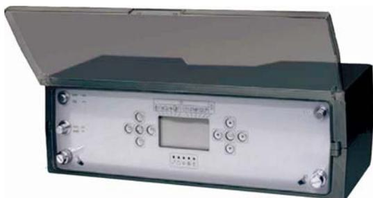
Пульт **CL-B** погодозависимого управления предназначен для управления «двухтопочными» котлами серий **RIELLO 3300 2F**, **RIELLO 3800 2F BTS**, **RIELLO RTQ 2F** оснащенных двумя модуляционными, одно или двухступенчатыми вентиляторными горелками, встроенным или отдельностоящим бойлером-аккумулятором и двумя циркуляционными насосами. Пульт реализует систему каскадного
