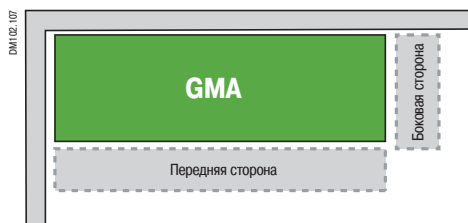
Классификация стойкости к внутренней дуге IAC: доступные стороны – FL
