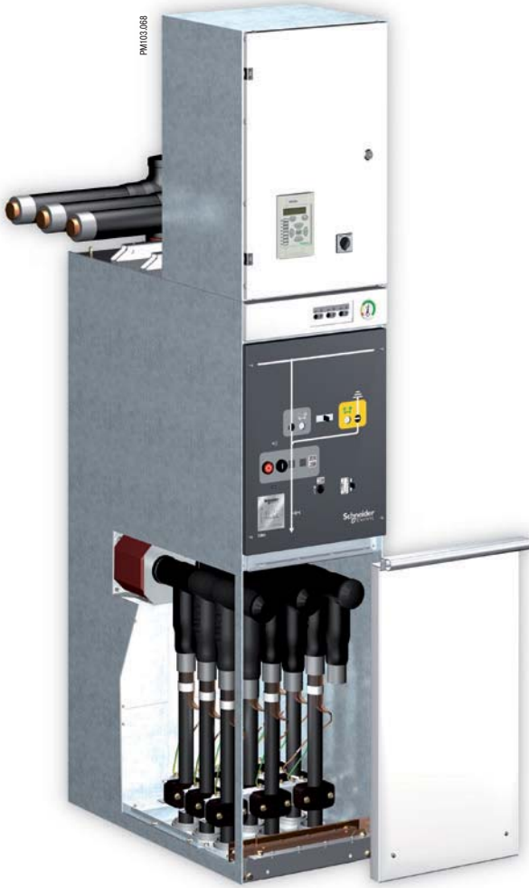
Ячейка шириной 450 мм, 3 кабеля на фазу + разрядник. На рисунке показана ячейка на токи до 800 А
