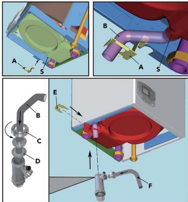
рис. 29 - Подсоединение трубы для слива конденсата
