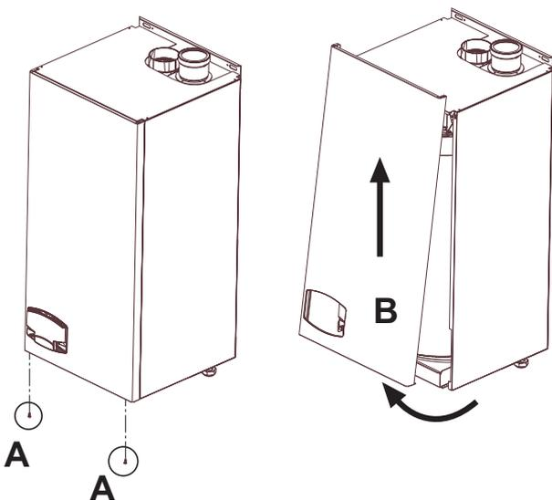
рис. 36 - Демонтаж кожуха
