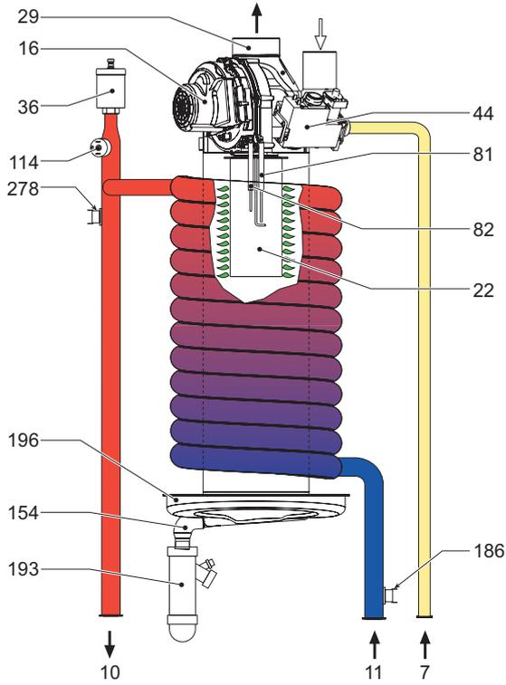
рис. 40 - Схема системы отопления и ГВС
