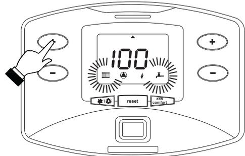
рис. 35 - Режим TEST (мощность системы отопления = 100%)
