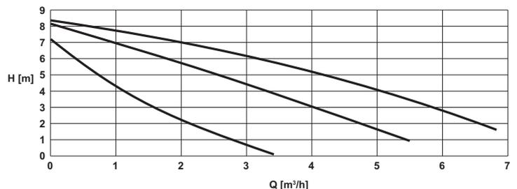
рис. 16 - Напор насоса
