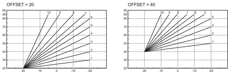
рис. 13 - Пример параллельного смещения кривых погодозависимого регулирования
