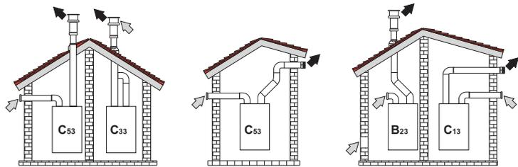
рис. 28 - Примеры подсоединения с помощью раздельных труб (⇐ = Воздух / ⇨ = дымовые газы)
