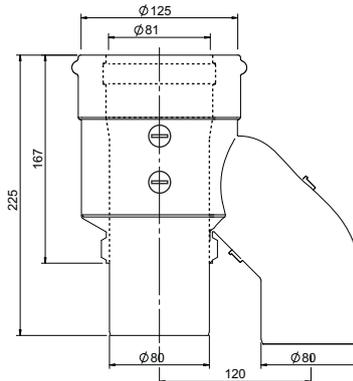
рис. 27 - Элементы для коаксиальных воздуховодов 041007X0
