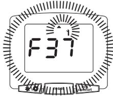
рис. 14 - Недостаточное давление воды в системе отопления
